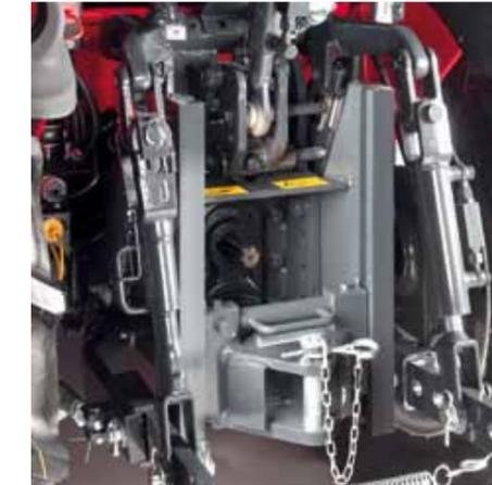
Avec le crochet de remorquage slider\* à réglage vertical rapide, on optimise la hauteur d'attelage de l'équipement tracté.
