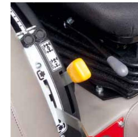
Le dégagement de la traction avant est utile pour les transferts sur route et élimine les dommages au sol sur les terrains délicats.
