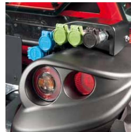
Relevage hydraulique: 1 distributeur à double effet + 1 à double effet avec position flottante + prise de retour d'huile. Total : 5 prises arrière
