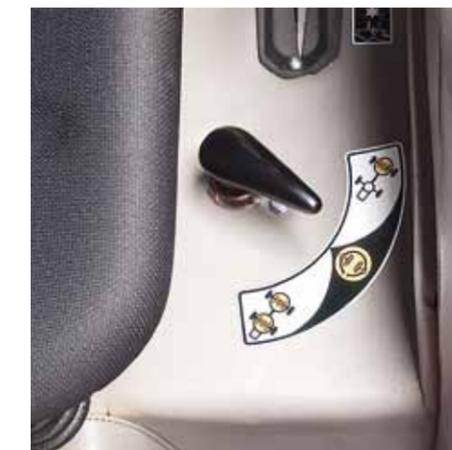
Le blocage arrière & avant des différentiels évite les glissements et optimise la traction.
