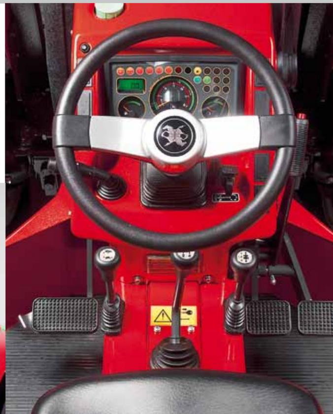
Le châssis ACTIO™ permet de faire coïncider le siège du conducteur avec le centre d'oscillation du tracteur, atténuant ainsi les secousses transversales et les cahots. De ce fait, le conducteur est bien moins fatigué même après de nombreuses heures de travail. Élégant, le tableau de bord est fonctionnel et intuitif avec un afficheur antireflet rétro éclairé la nuit, un système d'information « on-off », un compte-tours numérique et un autre pour la PDF, des
