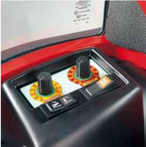
Botones para la posición de levante con memoria\*: dos potenciómetros para el ajuste del esfuerzo o posición y bloqueo hidráulico del elevador para el transporte en carretera.
