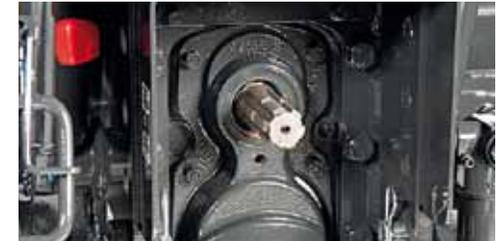
T. de F. de dos velocidades: 540 r.p.m. y, 540 E (750 r.p.m.) y sincronizada con la velocidad del cambio. El eje de la T. de F. es de tipo ASAE 1 3/8 y único para todas las velocidades.
