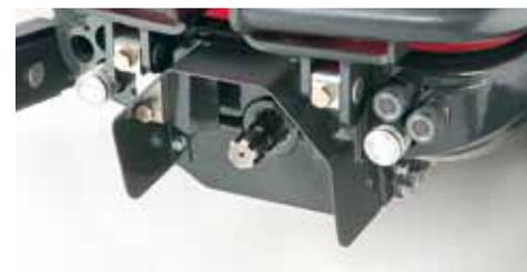
La T. de F., delantera\* (1000 r.p.m.) de mando electrohidráulico progresivo con botón de seguridad y sin necesidad de mantenimiento.
