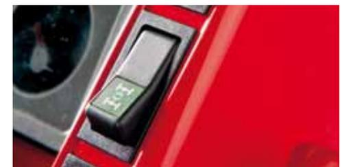
El bloqueo trasero de diferenciales evita patinajes y optimiza la tracción. La desconexión de la tracción delantera es útil en la circulación por carretera y evita daños al suelo en céspedes delicados.
