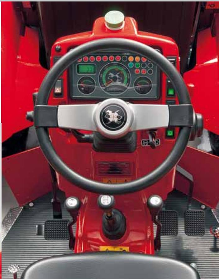
Gracias al bastidor ACTIO™ el puesto de conducción coincide con el centro de oscilación del tractor: así se reducen las oscilaciones y movimientos transversales y, incluso después de muchas horas de trabajo, no llega el cansancio. La instrumentación de a bordo es elegante, funcional e intuitiva: pantalla anti reflejos y retro iluminada para la noche, sistema de información "on-off"; taquímetro digital y cuenta horas de la T. de F.; mandos electro hidráulicos con botón de mando.
