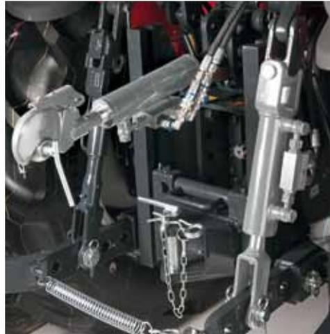
Tirante vertical hidráulico y tercer punto\* que facilitan el ajuste desde el puesto de conducción.
