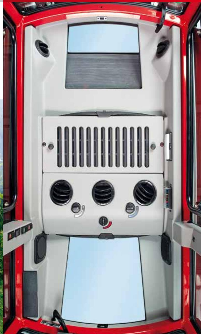
La ventilación forzada del sistema de climatización produce un efecto de presurización interna. El aire entrante está depurado por un filtro de grandes dimensiones que puede ser, opcionalmente, de carbono activo\*.
