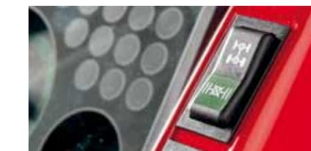
Le blocage arrière des différentiels évite les glissements et optimise la traction. Le dégagement de la traction avant est utile pour les transferts sur route et élimine les dommages au sol sur les terrains délicats.
