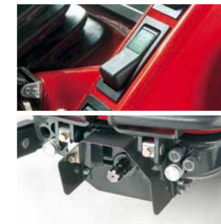
La PDF avant\* (1000 tr/min) à commande électrohydraulique à enclenchement progressif avec bouton-poussoir de sécurité ne nécessite aucun entretien.
