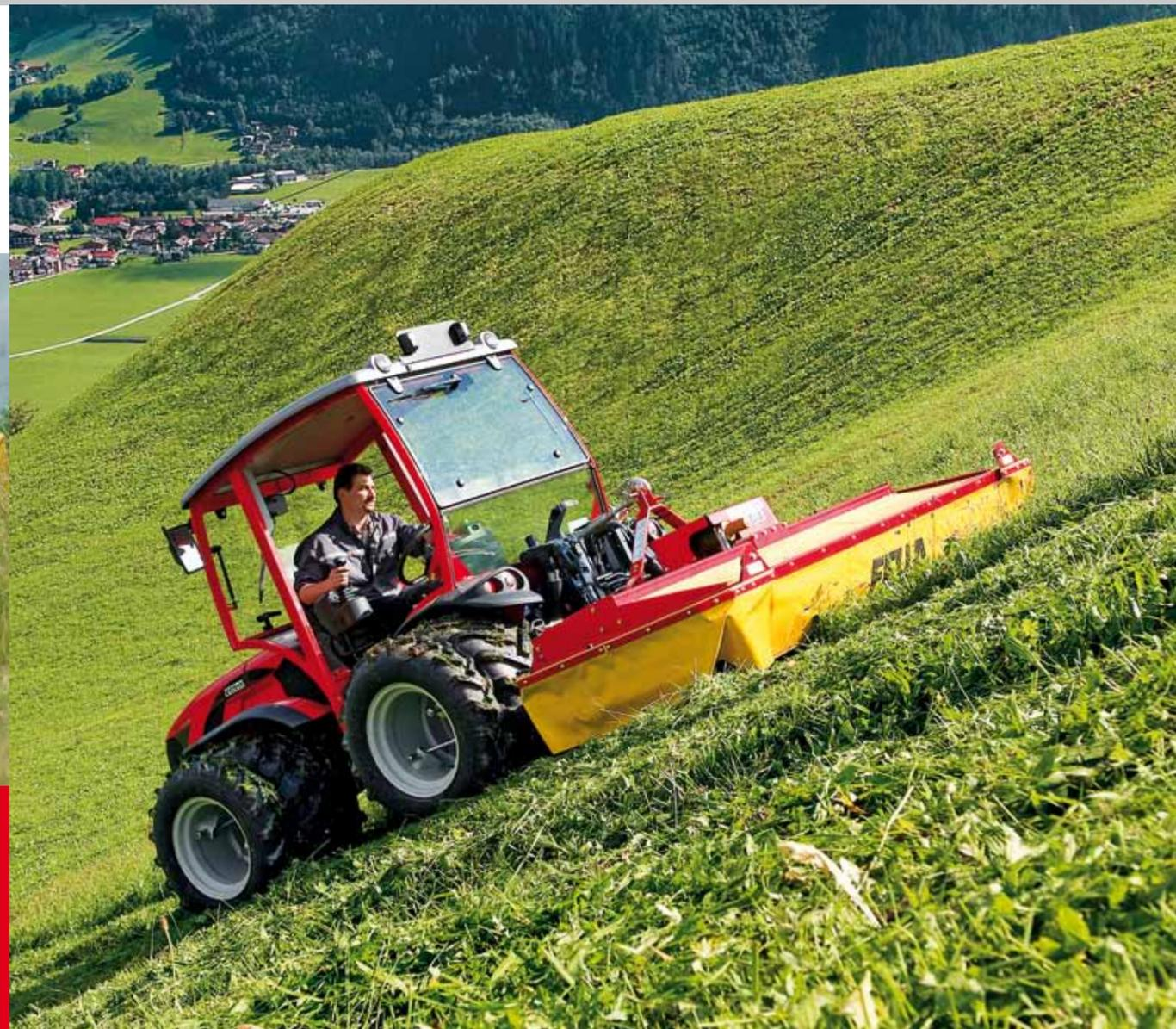
Faucheuse, pelle, chargeur, élévateur, enrubanneuse, semeuse, planteuse, fraise, bras latéral, lame et turbine à neige, tondeuse, remorque, atomiseur, broyeur ne sont que les équipements les plus communs utilisés avec les tracteurs TTR de la Série Ergit 100. La monte de pneumatiques est interchangeable pour que la différence d'adhérence sur chaque terrain accentue les performances du tracteur.
