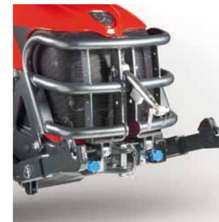
Le relevage avant\* optimise les travaux combinés avec des équipements arrière.
