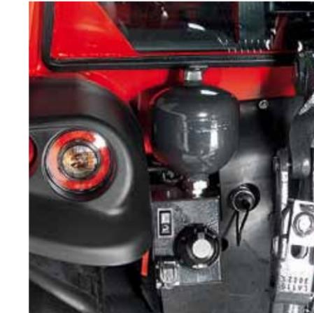
Suspension hydropneumatique à contrôle automatique de la pression.
