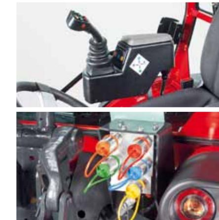
Circuit hydraulique à commande électrohydraulique avec joystick : 2 distributeurs à effet double + 1 à effet simple + 1 prise de retour d'huile. Total : 6 connexions rapides arrière.
