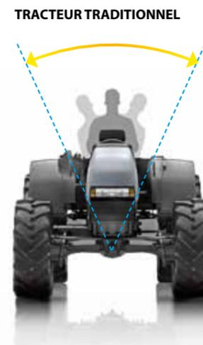
Les phares de travail sont intégrés dans le pare-chocs et utilisent des phares à parabole réfléchissante qui illuminent en profondeur le devant de la route ainsi que l'équipement de travail et le terrain aux alentours. Les opérations d'entretien sont aisées et rapides grâce au capot qui s'ouvre complètement, aux côtés latéraux et au couvercle de la batterie qui s'enlèvent facilement.
