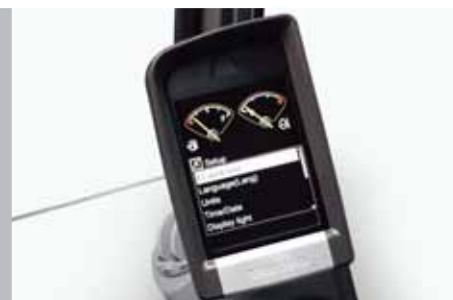
Marteau et cisaille : pré réglage variable du débit et de la pression
