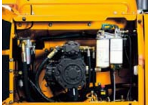
• Accesso facilitato alle pompe e filtri.
