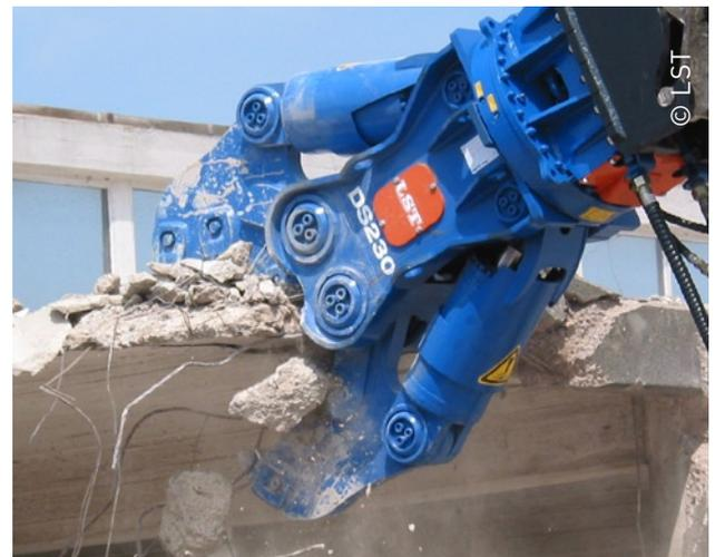
Durch das spezielle Eilgangventil öffnet und schließt die Zange äußerst schnell. Die Serie DS verfügt über einen LST HWRI Antrieb mit 360° Endlosdrehung und Drosseln für konstante und optimale Umdrehungsgeschwindigkeit - somit wird ein exaktes positionieren ermöglicht. Die Kombizange wird mittels schraubbaren Adapterplatten an das Trägergerät angebaut.
