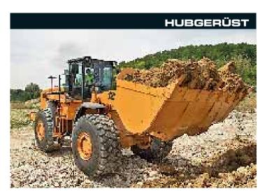
Das Modell 1221E ist mit einer robusten Z-Kinematik ausgestattet, die besonders hohe Grabkräfte erreicht und minimalen Materialverlust ermöglicht. Für Ladevorgänge, die größere Reichweiten bzw. Auskipphöhen erfordern, ist optional eine XR-Kinematik lieferbar. In der Serienausstattung mit Z-Kinematik bietet die Maschine eine gewaltige Losbrechkraft von 22.550 kg, und sogar eine Traglast von 31.690 kg bei Ausrüstung mit einer Standardschaufel mit 5,7 m³.
