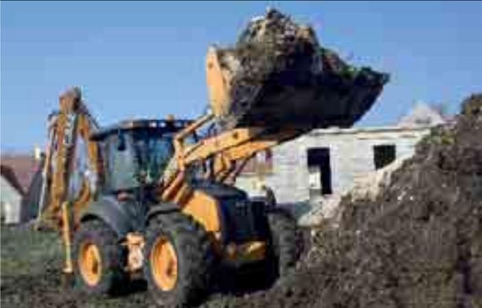
Das Modell 695 Super R Serie 3 ist mit einer Ladeschaufel von 1,2 m<sup>3</sup> ausgestattet, die 20 % größer als die der Modelle 580 Super R Serie 3 und 590 Super R Serie 3 ist. Der robuste Lader ist serienmäßig mit mechanischer Parallelführung, automatischer Schwimmstellung und automatischer Schaufelrückführung ausgestattet.
