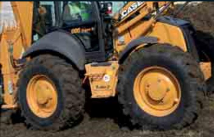
Dank der vier gleich großen Räder verfügt die Maschine über eine insgesamt höhere Bodenfreiheit. Das Modell 695 Super R Serie 3 hat drei Lenk-Betriebsarten, nämlich Vorderradlenkung, Allradlenkung für maximale Manövrierfähigkeit und Hundegang, der ideal für das Verfüllen und Nivellierarbeiten geeignet ist.
