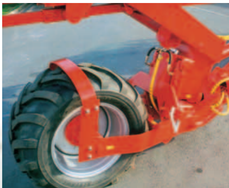
La rueda del arado está equipada de serie con una suspensión hidroneumática.
