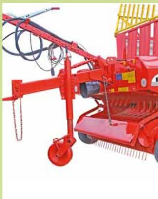
Le timon hydraulique (en option), conférant un dégagement sous pick-up de 60 cm, permet de rouler sans problèmes sur le silo et sur terrains accidentés.
