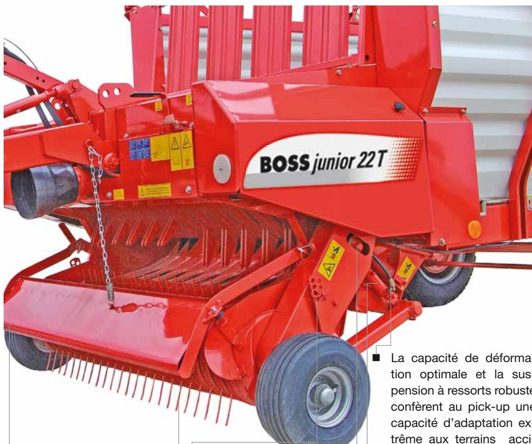
■ Les tôles de pick-up, cintrées vers l'extérieur, guident chaque brindille vers le canal de chargement. La tôle à andain, réglable en hauteur garantit un ramassage efficace du fourrage court.
