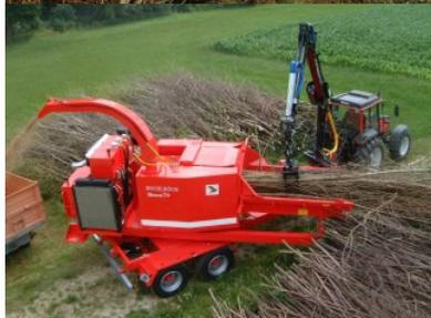
Die Baureihe Biber 70 wurde speziell aus den Bedürfnissen der Praxis für die Kranbeschickung entwickelt. Wichtig ist ein starkes, aggressives Einzugsystem mit 2 Einzugswalzen oben und einem Ketteneinzugsband unten für eine einfache und effektive Beschickung, sowohl von Stammholz als auch von Strauchmaterial.
