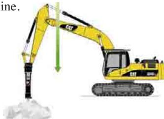
**Hammerarbeiten.** Der Hammer dringt durch sein Eigengewicht ohne zusätzlichen Anpressdruck in das Brechgut ein und schädliche Leerschläge werden vermieden. Ähnliche Vorteile ergeben sich beim Arbeiten mit Verdichtertafeln.
