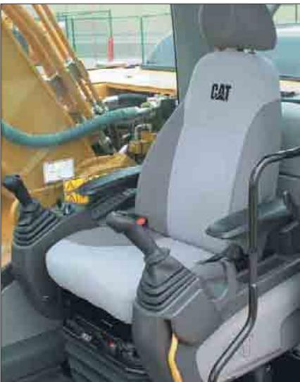
**Steuerhebelkonsolen.** Beide Steuerhebelkonsolen wurden neu gestaltet, um die Funktionalität zu verbessern und dem Fahrer ein ermüdungsarmes, produktives Arbeiten zu ermöglichen. Die in der Höhe verstellbaren Armlehnen sind direkt mit den Konsolen verbunden.
