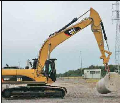
**Schwerlast-Hubfunktion.** Mit der serienmäßigen Schwerlast-Hubfunktion lässt sich per Tastendruck die Tragfähigkeit bei Hebeeinsätzen erhöhen und zugleich die Feinsteuerung verbessern.
