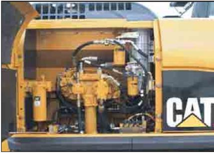
**Luftfilter.** Das zweistufige Trockenfiltersystem erzielt einen sehr hohen Abscheidegrad. Bei übermäßiger Filterverschmutzung wird eine Kontrollleuchte im Display aktiviert.
