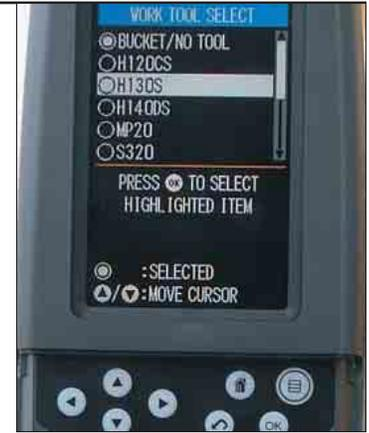
**Steuer- und Überwachungssystem.** Am Monitor können Volumenstrom- und Druckwerte für bis zu zehn Anbaugeräte eingegeben, gespeichert und jederzeit wieder aufgerufen werden.
