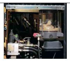
Zentralschmieranlage. Die optionale Zentralschmierung pumpt automatisch die erforderliche Fettmenge zu den Hauptschmierstellen. Am Kabinenmonitor lassen sich die Schmierintervalle bequem einstellen und auf dem Display werden Statusmeldungen angezeigt.
