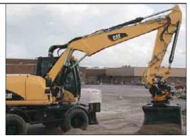
**Energieverwertung.** Der Stielkreis ist mit einem Energieverwertungssystem ausgestattet, das die Energiebilanz der Hydraulik verbessert und die Arbeitstakte beschleunigt.
