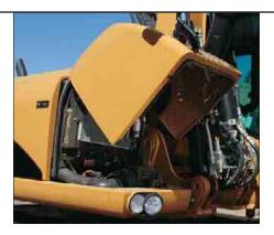
**Frontraum.** Im rechten Frontraum des Oberwagens sind Batterien, Ladeluft-kühler, Kältemittelkondensator und Luftfilter geschützt und bestens zugänglich untergebracht.
