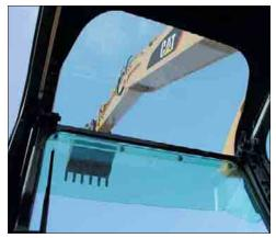
**Kabinenfenster.** Um die bestmögliche Rundumsicht zu erzielen, sind alle Glasscheiben direkt mit der Fahrerkabine verklebt, sodass sichtbehindernde Rahmen entfallen können.
