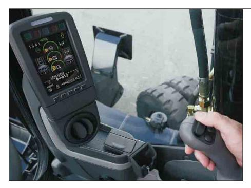
Anbaugerätesteuerung. Im Speicher des Monitors können beliebige Volumenstrom- und Druckwerte für bis zu zehn verschiedene Anbaugeräte mit Ein- oder Zweiwegefunktion unter eigenen Namen abgelegt werden, sodass umständliche Neueinstellungen nach einem Werkzeugwechsel entfallen. Die programmierten Werte sind jederzeit per Tastendruck abrufbar. Exklusive Cat Schiebeschalter in den Joysticks ermöglichen eine feinfühlige proportionale Ansteuerung.
