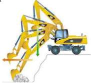
**LKW-Beladung.** LKWs/SKWs lassen sich von einer erhöhten Standebene aus produktiver und kraftstoffsparender beladen, weil sich der Ausleger durch sein Eigengewicht absenkt.
