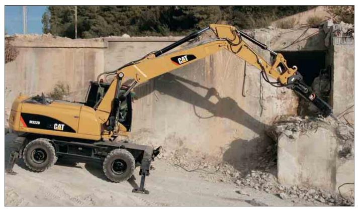
Konstruktion. Ausleger und Stiele sind als groß dimensionierte, geschweißte Kastenprofile aus dicken Stahlblechen mit Verstärkungen in den hochbelasteten Zonen gefertigt und bieten daher eine überragende Verwindungssteifigkeit und Dauerfestigkeit.
