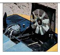
Kühler. Glatte Kühlrippen an allen Kühlern verringern die Verstopfungsgefahr. Hauptlüfter und Kältemittelkondensator sind zudem schwenkbar ausgeführt, um Reinigungsarbeiten zu erleichtern.
