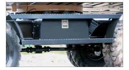
Konstruktion. Der geschweißte Hauptrahmen zeichnet sich durch hervorragende Verwindungssteifigkeit und Dauerfestigkeit aus. Sorgfältig verlegte und stabil befestigte Hydraulikleitungen sowie Getriebeschutzabdeckung und HD-Antriebsachsen verringern die Beschädigungsgefahr bei typischen Mobilbaggereinsätzen. Am Unterwagenheck befindet sich der serienmäßige Abstütz-Planierschild, der bei Bedarf durch frontseitige Abstützpratzen ergänzt werden kann.
