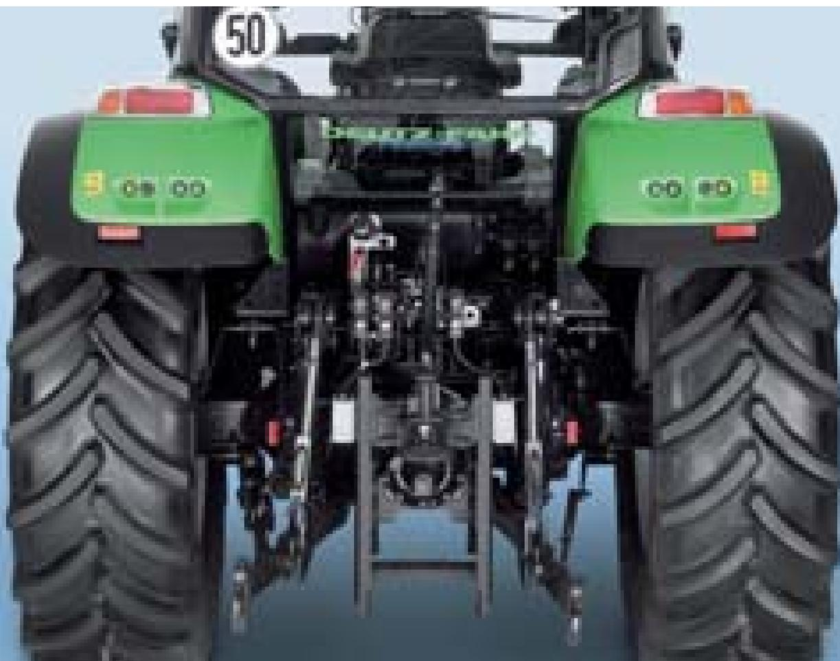
Gli Agrottron K sono equipaggiati di sistema idraulico a "centro aperto" (pompa con portata di 61 o 75 l/min.), oppure a centro chiuso (con pompa a portata variabile da 83 l/min.) con Load Sensing.
