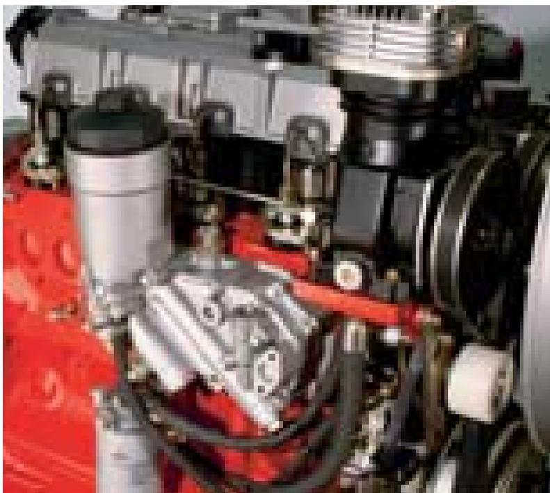
Grazie a particolari caratteristiche progettuali e alla scelta di materiali costruttivi idonei, i motori degli Agrottron K sono in grado (mediante apposito kit) di garantire una perfetta funzionalità e una totale compatibilità con il biodiesel, fino ad una percentuale di utilizzo del 100% (Biodiesel rispondente alle specifiche EN 14214:2003).
