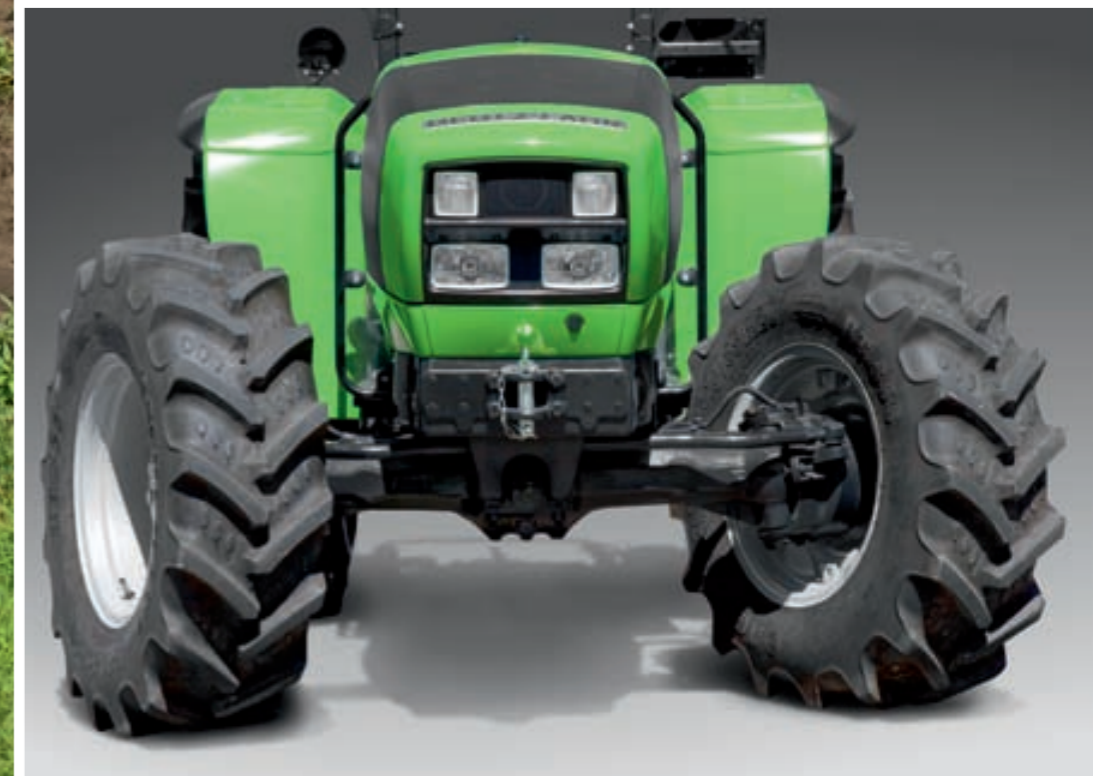
Mit einem Einschlagwinkel von 55° und hoher Bodenfreiheit: Die robuste vordere Antriebsachse.
