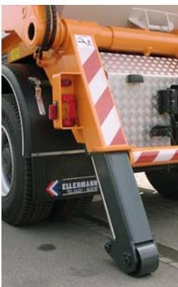
Schräg nach hinten wirkende Abstützungen, getrennt steuerbar, mit Ablaufrollen zur Erhöhung der Standsicherheit beim Kippen
