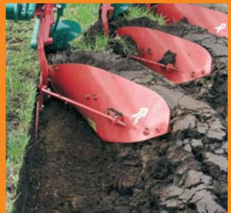
Der Körper Nr. 28 wendet hervorragend und hinterlässt eine breite Furche. Speziell für Traktoren mit Breitreifen.
