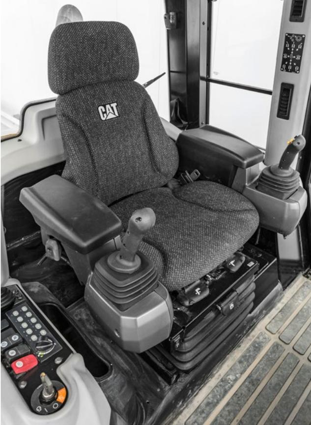
Die verbesserte Kabine bietet dem Fahrer zusätzlichen Komfort wie einstellbare Armlehnen und Steuerungen, eine verbesserte Klimaanlage und einen als Sonderausstattung erhältlichen beheizbaren/belüfteten Sitz. Die LCD-Fahrerschnittstelle erleichtert die Anpassung der Maschinenleistung und das Anzeigen von Informationen zu Betrieb und Wartung.
