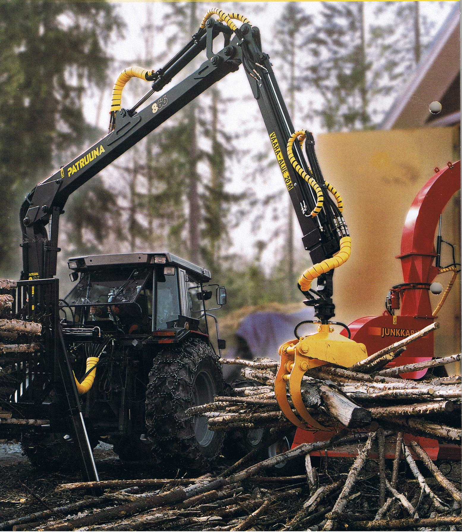
Die Patruuna-Kräne werden nach den Bedürfnissen des Kunden maßgeschneidert. Zur Auswahl stehen mehrere Ventilblock-, Stammgreifer-, Greiferschwenkwerk- und Stützbeinalternativen mit zahlreichem Zubehör.
