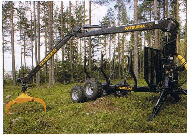
Alle Patruuna-Holzrückeanhänger sind mit frei verschiebbaren Rungen und Boggies versehen. Die kugelgelagerte Deichsellenkung ist serienmäßig mit zwei Hydraulikzylindern ausgestattet. Dadurch kann der Anhänger dem Traktor gut folgen. Die Lenkdeichsel verringert den Wenderadius der Kombination. Wird beim Ladevorgang die Armlenkung angewandt, kann die Reichweite des Krans um bis zu 70 cm verlängert werden.
