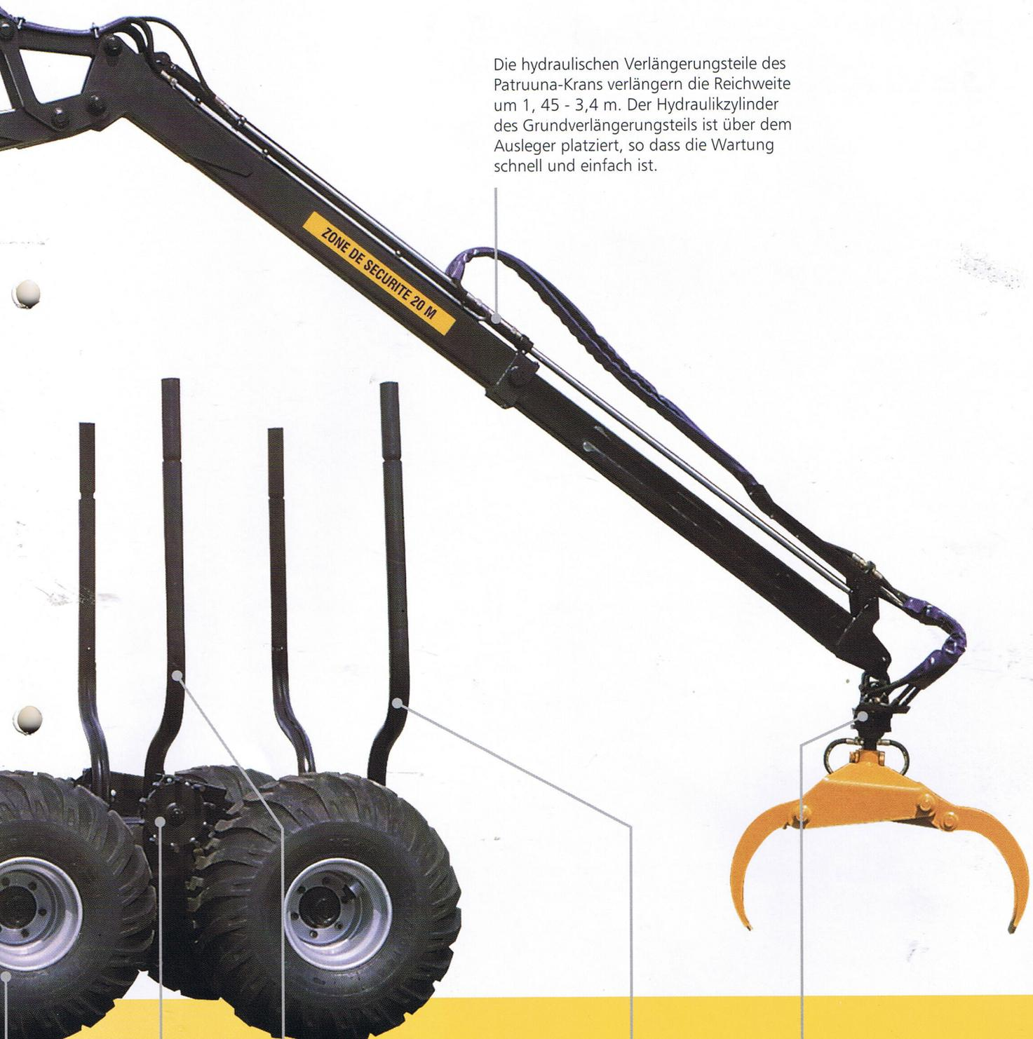
Die hydraulischen Verlängerungsteile des Patruuna-Krans verlängern die Reichweite um 1,45 - 3,4 m. Der Hydraulikzylinder des Grundverlängerungsteils ist über dem Ausleger platziert, so dass die Wartung schnell und einfach ist.
