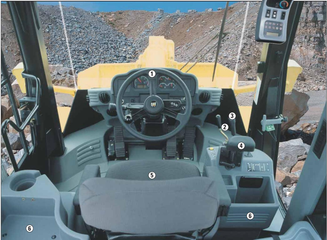
**1 Standardlenkrad** – Griffiger Lenkradkranz, praktischer Lenkradknopf und verstellbare Lenksäule erleichtern dem Fahrer die Arbeit.
