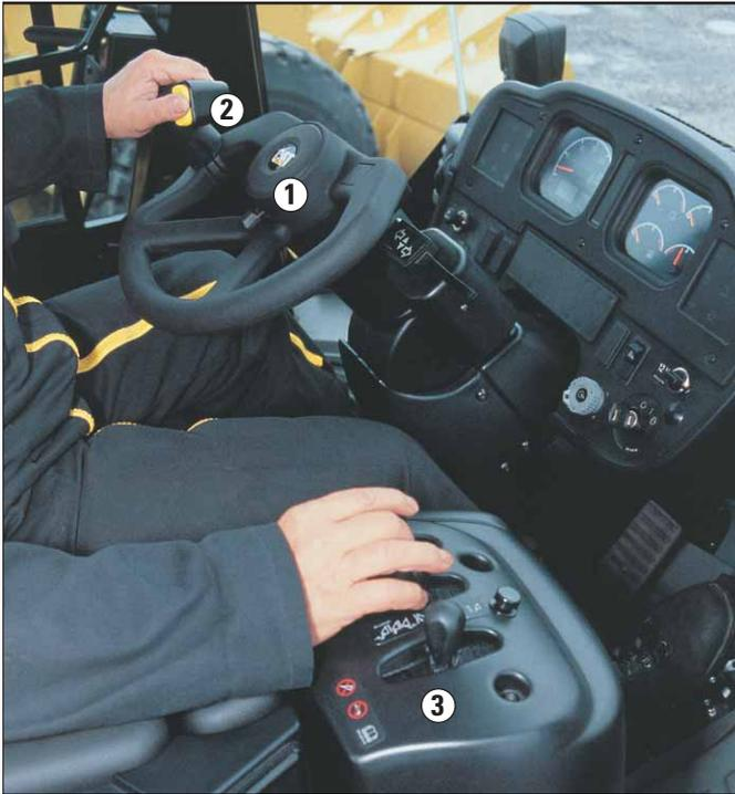
**Lenkung.** Der 962G-II ist mit zwei verschiedenen Lenksystemen lieferbar. Bei der Version mit Direktlenkung wird die Arbeitshydraulik mit einer elektrohydraulischen Vorsteuerung ausgerüstet, während Maschinen mit Normallenkung eine hydraulische Vorsteuerung besitzen.
