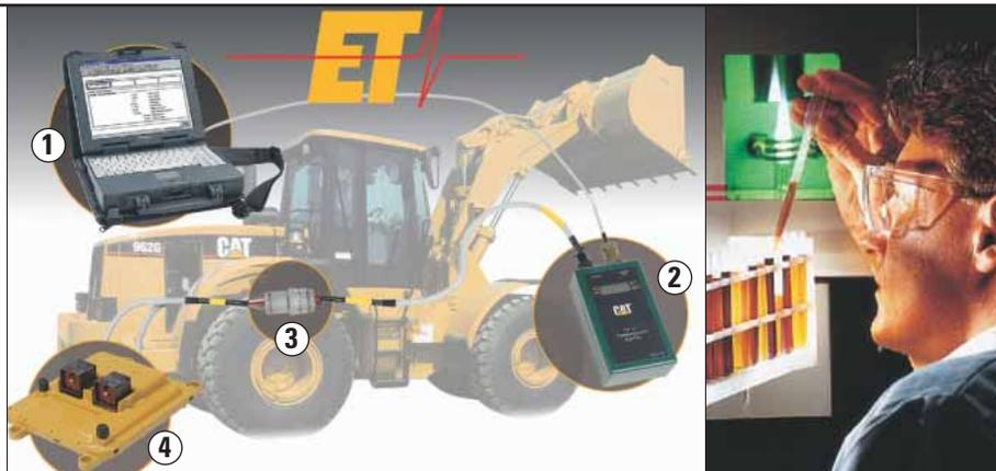
**Prüfsoftware.** Bei der Cat PC-Prüfsoftware *Elektroniktechniker (ET)* handelt es sich um ein praxisgerechtes Hilfsmittel zum Erkennen und Analysieren von Maschinenfehlern, denn es erlaubt den direkten Zugriff auf die elektronischen Steuergeräte der Maschine.
