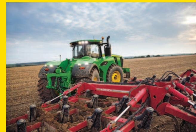
Les tracteurs de la série 9R trouvent la combinaison idéale entre rapport de vitesse et régime moteur pour chaque application grâce à la transmission e18 avec Efficiency Manager, réduisant ainsi la consommation de carburant.
