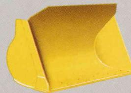
**Godets normaux Caterpillar** conçus pour résister à l'usure et aux chocs. Plaques et renforts faits d'épaisse tôle d'acier allié avec soudures profondes continues. Traitement thermique du bord tranchant, des plaques de coin et des flancs de godet conférant à l'ensemble une robustesse et une résistance à l'usure élevées. En option, dents à boulonner.
