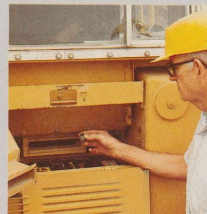
Pour déposer la batterie, il suffit d'ouvrir une porte de service et de déposer le panneau inférieur. (Sur les machines équipées d'une pelle rétro, la batterie se trouve sous le siège basculant.)
