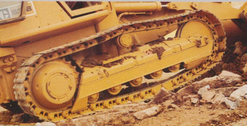
L'abrasion sévit en permanence – contact métal contre métal . . . métal contre poussière et pierres . . . métal dans la boue et dans l'eau. Le train de roulement de votre chargeur à chaînes doit pouvoir encaisser ces mauvais traitements – pour que votre entreprise n'en souffre pas. Les opérations d'entretien ou de remplacement du train de roulement sont coûteuses en temps et en argent, ce poste pouvant
