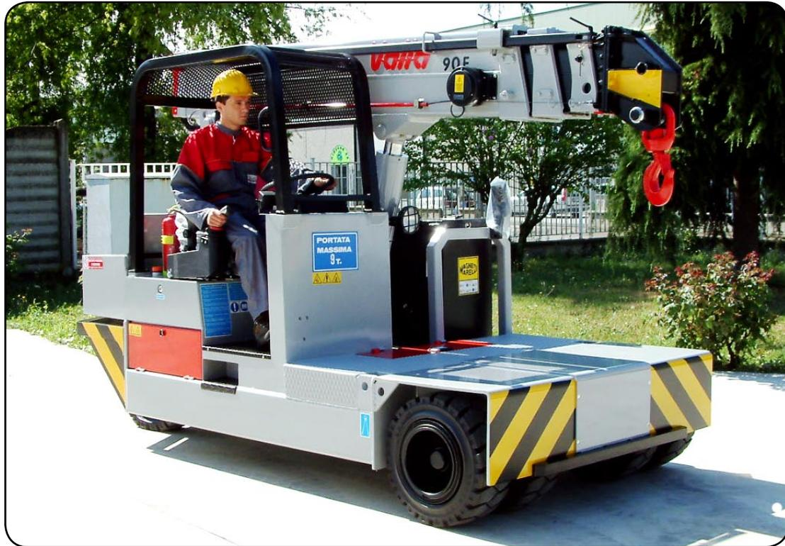
**TRAZIONE:** con motore elettrico DC kW 10 - 48 V, autoventilato, reversibile, comandato da variatore elettronico di velocità a MOSFET ad alta frequenza con recupero di energia, autodiagnosi, controllo di velocità, controllo di temperatura (n° 2 termostati) ed allarme di usura spazzole.
