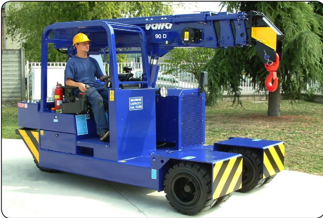
**MOTORE:** turbo diesel 4 cilindri, raffreddato ad acqua, HP 51 - kW 38.
