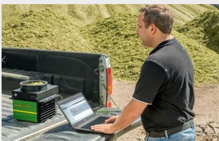
Il sensore John Deere HarvestLab 3000 può essere utilizzato durante tutto l'anno anche come unità di laboratorio in un magazzino o in ufficio. Collegandolo alla presa di alimentazione di un veicolo, invece, diventa un laboratorio portatile in grado di fornire informazioni all'istante in qualunque luogo.
