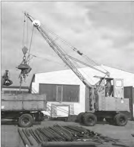
1962: Seilbetriebener S833 mit erhöhter Fahrerkabine
