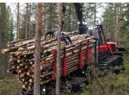
La grue d'une longue portée et d'une force de levage nette élevée est équipée d'une solution de passage de flexibles et de colonne de toute fiabilité et du balancier Combi. Tilt de grue (option) pour une meilleure efficacité de chargement sur les terrains en pentes.
