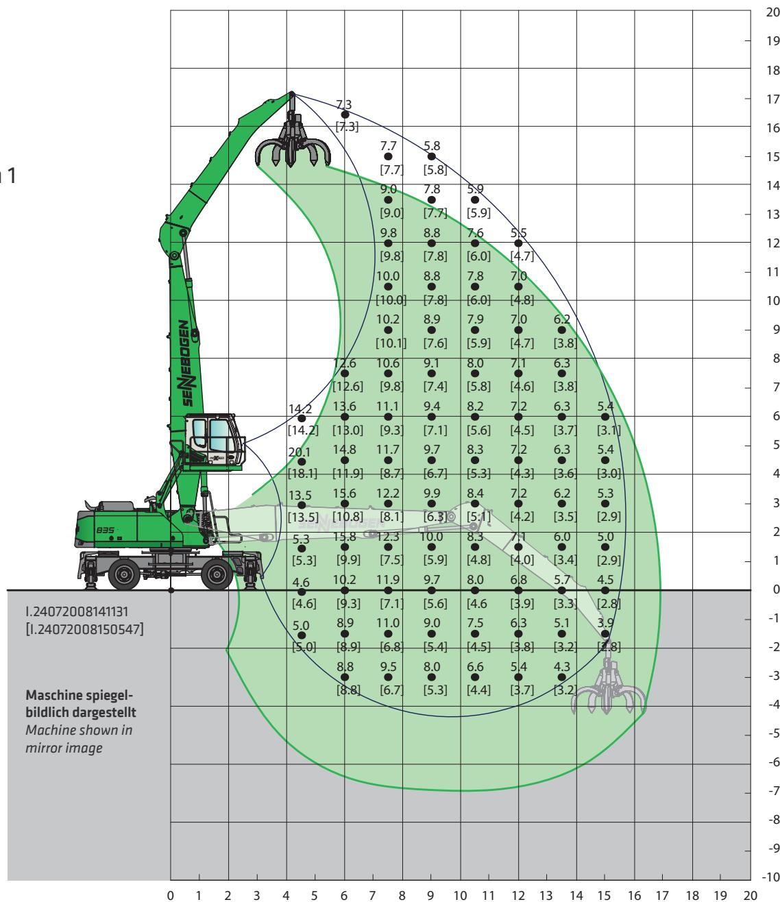
**Unterwagen** *undercarriage***Kompaktausleger** *compact boom***Ladestiel** *Loading stick***Kabine** *cabin***MP41 E****9,1 m****6,9 m****maXcab E270, hydraulisch hochfahrbar****maXcab E270, hydraulic elevating**
