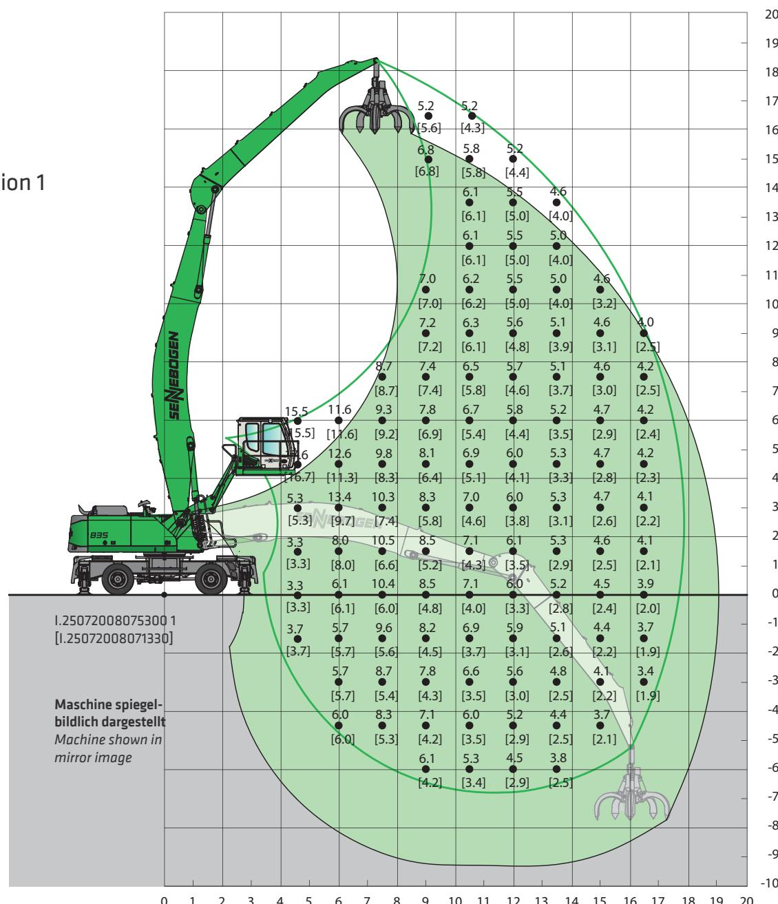
**Unterwagen** *undercarriage***Kompaktausleger** *compact boom***Ladestiel** *Loading stick***Kabine** *cabin***MP41 E****10,8 m Banana****7,9 m****maXcab E300/260, hydraulisch hoch- und vorfahrbar****maXcab E300/260, hydraulic elevating and forward moving**
