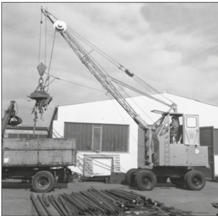
1962: S833 operando por cable con cabina del conductor elevada
