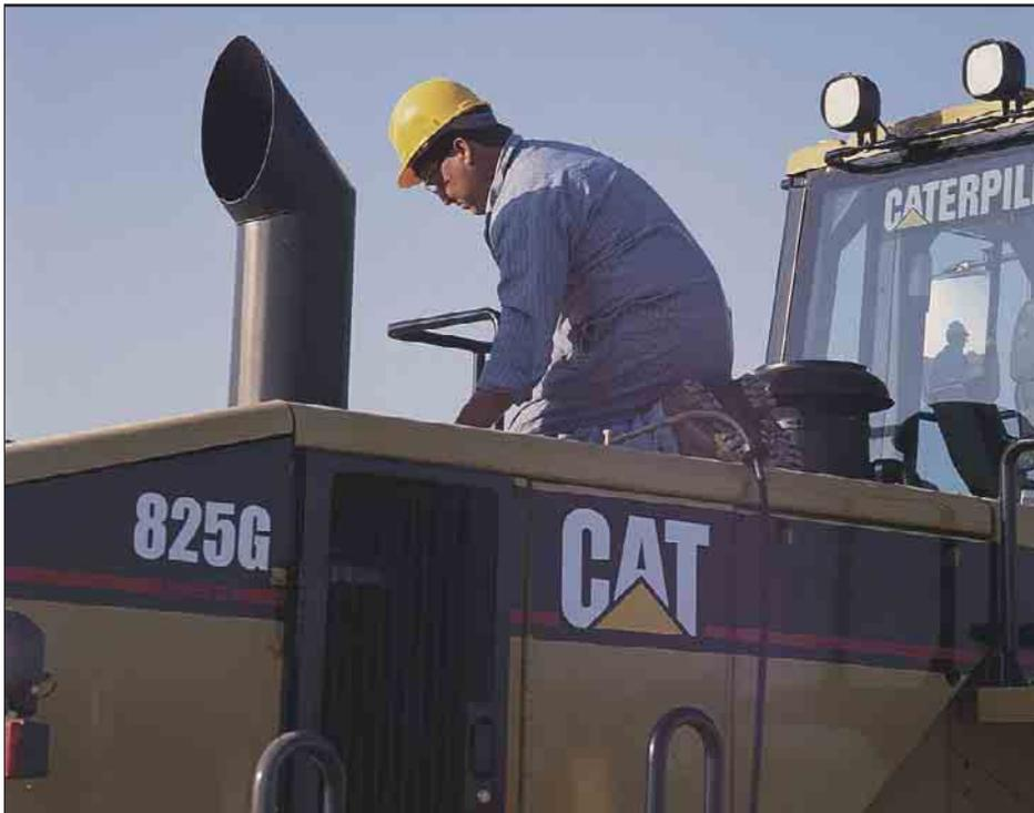
**Motorhaube.** Anstelle der bisher verwendeten Kunststoff-Motorhaube wird der 825G-II jetzt mit einer robusten Motorraumverkleidung aus Stahl geliefert, die sich durch eine bessere Dauerfestigkeit bei schweren Einsätzen auszeichnet.
