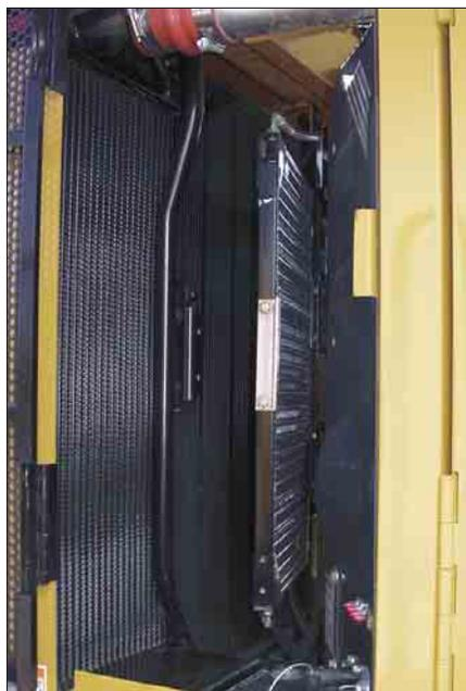
**Kältemittelkondensator.** Der zur serienmäßigen Klimaanlage gehörende Kältemittelkondensator lässt sich um 30° ausschwenken, um Reinigungsarbeiten zu erleichtern.
