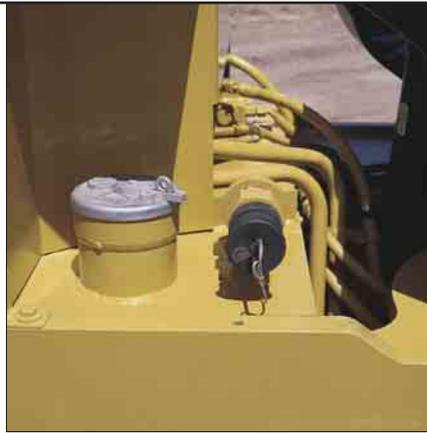
**Schnellbetankungssystem.** Pro Minute strömen bis zu 380 Liter Kraftstoff durch die Zapfpistole direkt in den Tank. Während sich der Tank füllt, wird die Luft durch das Entlüftungsventil herausgedrückt. Sobald der Tank vollständig gefüllt ist, schließt sich das Ventil und die Zapfpistole schaltet automatisch ab.
