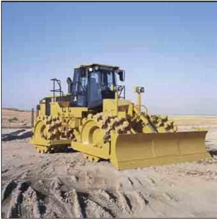
**Ausrüstung.** Zur Planierschild-Ausrüstung gehören zwei Schubarme, zwei Drehzapfen, durchgängiges Gleitblech mit auswechselbaren Verschleißblechen, umkehrbare Planiermesser-Segmente, selbstschärfende Endstücke, Hubzylinder sowie Hydraulikleitungen einschließlich Schutzabdeckung.
