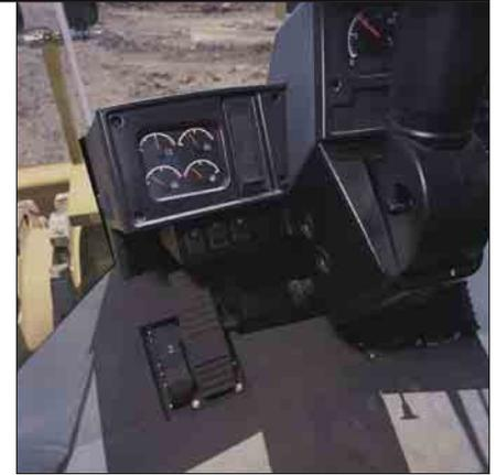
**Linkes Bremspedal.** Das linke Pedal steuert nicht nur die Bremsen an, sondern reduziert auf der ersten Hälfte des Stellwegs die Motordrehzahl, bevor die Bremse anspricht. Dabei wird die Drehzahlautomatik gegebenenfalls übersteuert und der Motor nach Loslassen des Pedals sofort wieder auf die eingestellte Drehzahl beschleunigt.
