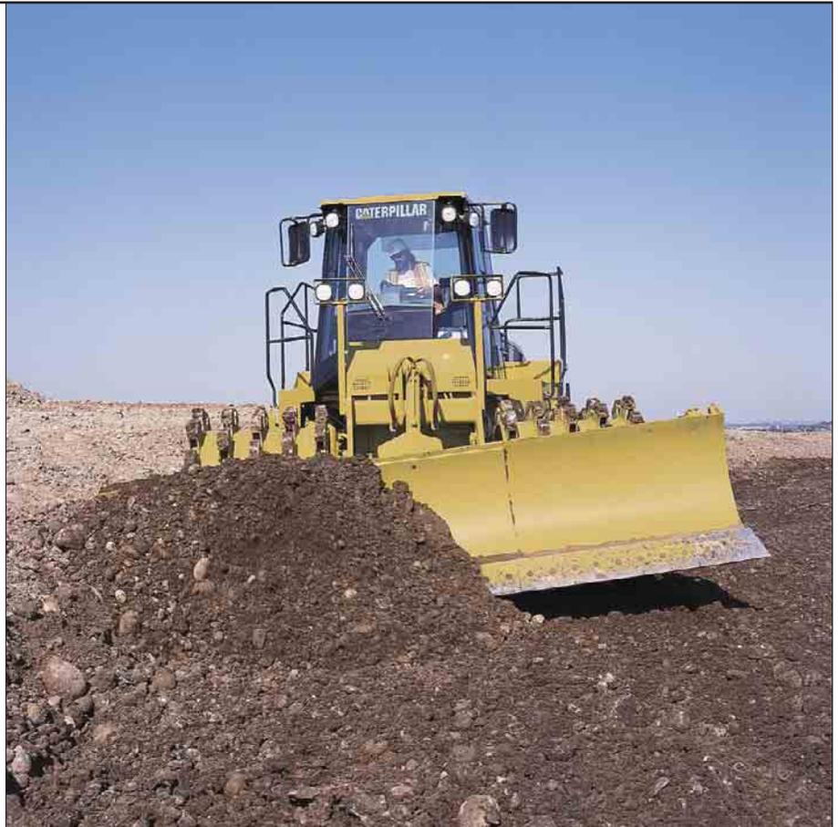
**Konstruktion.** Verwindungssteife Kastenprofilsegmente mit mehrteiligem Planiermesser aus hoch verschleißfestem Cat DH-2™ -Stahl garantieren lange Standzeiten bei schwersten Einsätzen. Der größte Teil der Belastungen wird über die außenliegenden Schubarme direkt in den Hauptrahmen eingeleitet, sodass sich die Beanspruchung des Schilds deutlich reduziert. Zudem kann bei dieser Bauweise ein breiterer Schild verwendet werden.
