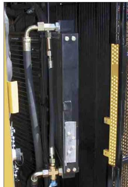
**Hydraulikölkühler.** Auch der Hydraulikölkühler kann ohne Werkzeug um 30° geschwenkt werden.
