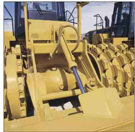
**Hubzylinderleitungen.** Um die Beschädigungsgefahr der Leitungen zu vermindern, wurden sie so hoch wie möglich im Vorderwagen angeordnet.
