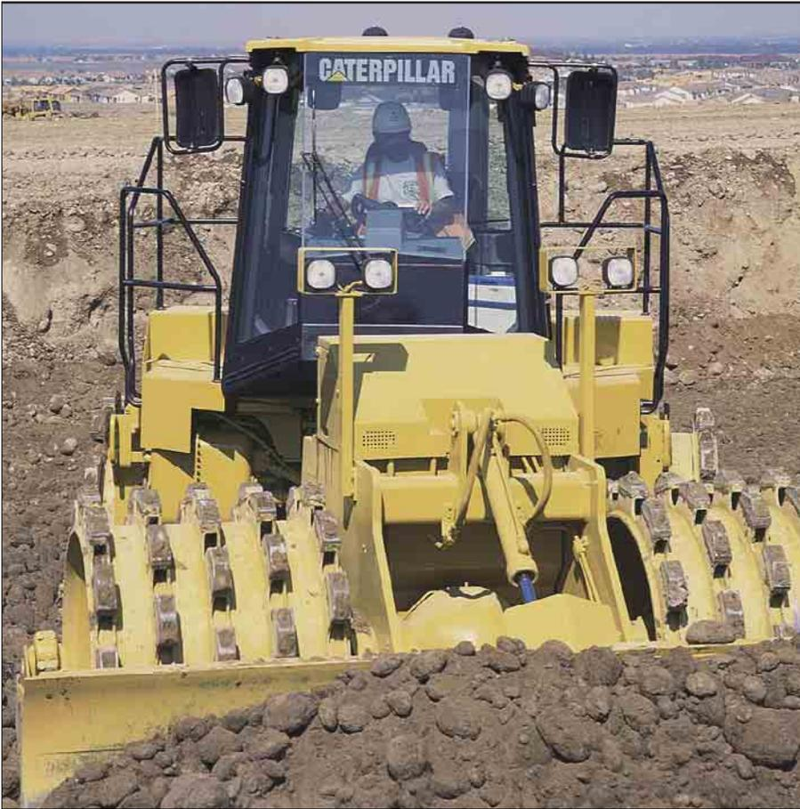
**Schildsteuerung.** Der auf leichten Fingerdruck reagierende Steuerhebel sendet elektrische Stellsignale an die hydraulischen Vorsteuerventile auf dem Vorderwagen. Bei dieser fahrerfreundlichen Lösung befinden sich keine lärm- und hitzeerzeugenden Hydraulikbauteile mehr innerhalb der Kabine.
