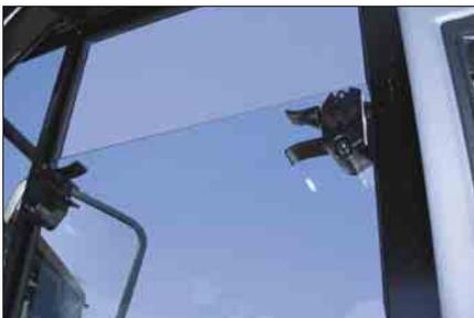
**Schiebefenster.** Rechtes und linkes Schiebefenster ermöglichen eine zusätzliche Belüftung des Innenraums und erleichtern bei geschlossenen Türen die Verständigung mit außenstehenden Personen.
