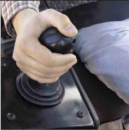
**Schildsteuerung.** Die Ansteuerung der Schildhydraulik erfolgt über einen leichtgängigen, ergonomisch geformten Kreuzsteuerhebel, der griffgünstig auf einer Konsole an der rechten Seite des Fahrersitzes angeordnet ist. Um eine natürliche Stellung des Armgelenks zu gewährleisten, weist die Konsole einen Neigungswinkel von 18° auf.
