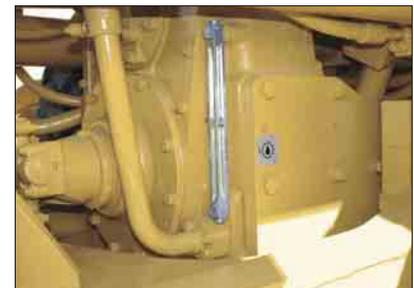
**Getriebeöl-Einfüllrohr.** Zusammen mit dem Getriebeöl-Schauglas befindet sich das Getriebeöl-Einfüllrohr direkt unterhalb der Plattform.
