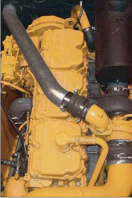
**Dieselmotor.** Beim Sechszylindermotor 3406E mit Abgasturbolader, luftgekühltem Ladeluftkühler und elektronischer Hochdruck-Direkteinspritzung handelt es sich um eines der leistungsfähigsten, zuverlässigsten und langlebigsten Triebwerke im umfangreichen Caterpillar Lieferprogramm.
