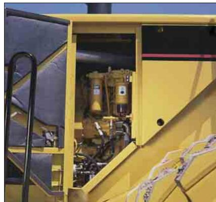
**Zugang.** Alle Wartungspunkte sind bestens zu erreichen. Von der Kabine aus hat man den Wartungsanzeiger des Luftfilters im Blickfeld. An den Luftfilter selbst kommt man direkt von der linken Plattform heran. Der Motorölfilter ist mühelos von der hinteren Plattform aus zugänglich. Ein Fernschmiernippel erleichtert das Abschmieren der Hubzylinderaufhängung. Herausnehmbare Bleche geben den Zugriff auf Komponenten frei, die seltener gewartet werden müssen.
