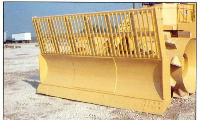
**Der Müllverteilschild** ist eine Mehrfach-Kastenprofilkonstruktion mit einem Schildkörper aus warmvergütetem Stahl sowie Planier- und Eckmessern aus DH-2-Stahl. Die komplette Schild-Baugruppe umfaßt den Schild, die Schubarme, umkehrbare Planiermesser, Eckmesser und die Hydraulikhubzylinder.
