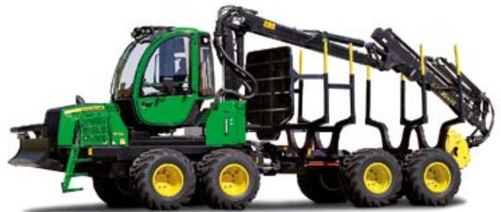
azität von 11 Tonnen wartet der 1010E mit einem leistungsstarken CF5-Kran auf und ist mit drei verschiedenen langen Ladeflächen erhältlich.
