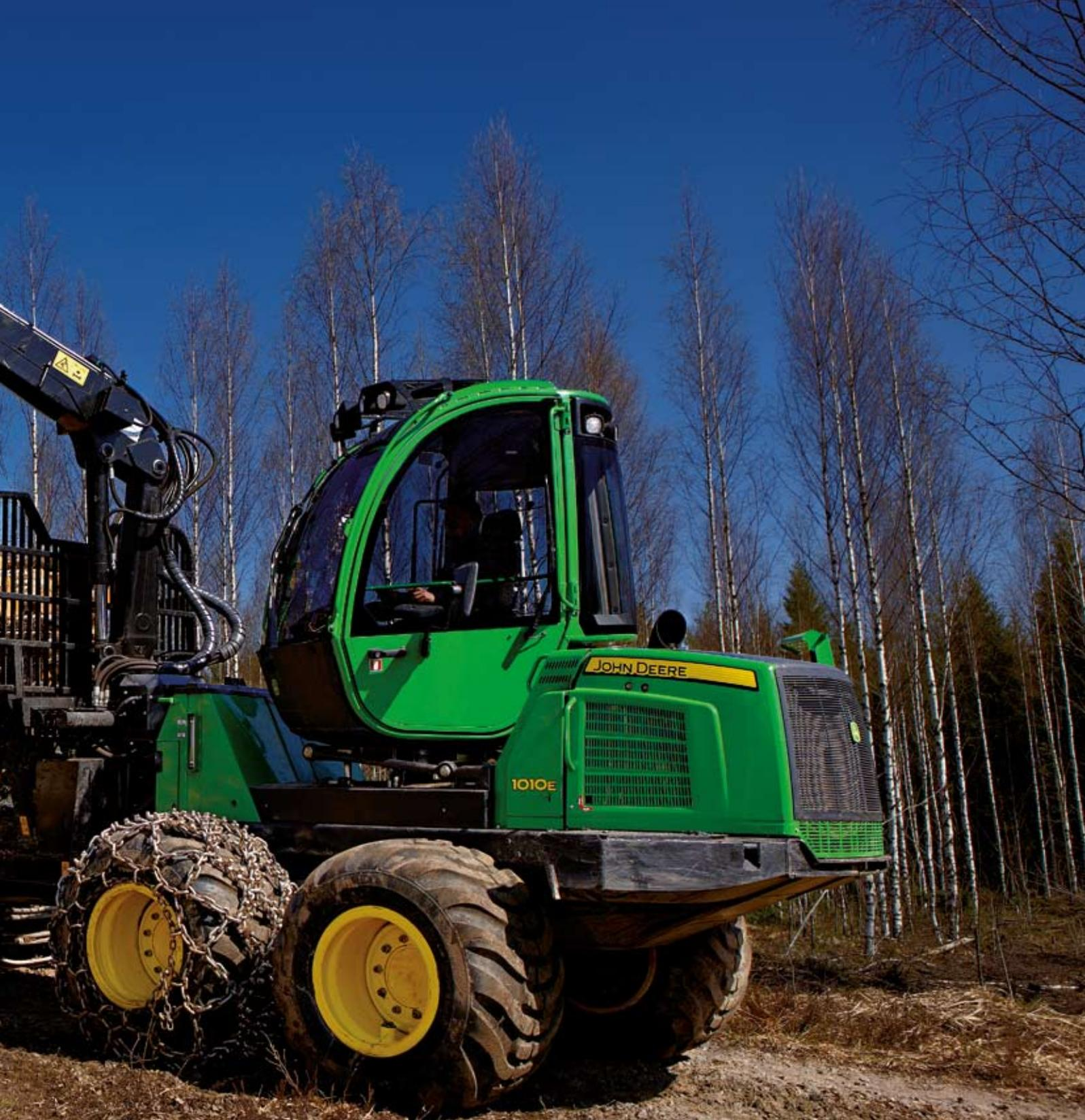
Das CF5-Modell mit 10 m Reichweite ist insbesondere für die Durchforstung sehr dichter Bestände mit geschützt verlegten Schläuchen erhältlich.
