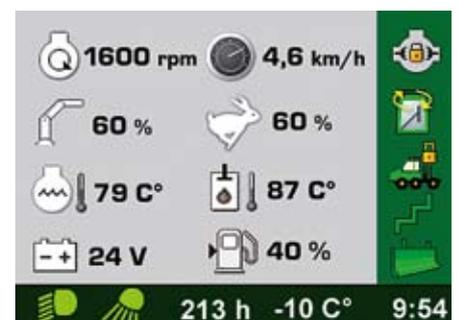
CommandCenter ist eine Bedienerschnittstelle für Rückzüge, an der die meisten Einstellungen vorgenommen werden. Diese Alternativlösung macht vor allem dann Sinn, wenn kein rechnergestütztes Multifunktions-Steuersystem erforderlich ist.
