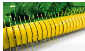
Stálá kvalita řezu. Nože jsou umístěny blízko rotoru, čímž se dosahuje konzistentní délky řezu.
