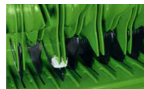
Individuální odpružení nože. Každý nůž v novém modelu MaxiCut 25 je vybaven pružinou, která zajišťuje zvýšenou ochranu v kamenitých polích a optimální kvalitu řezu.
