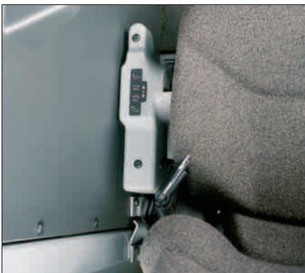
**14 Muldensteuerhebel** – Dank der elektrohydraulischen Steuerung lässt sich der Hebel mit leichtem Fingerdruck betätigen. Die Endlagendämpfung bewirkt ein weiches Absenken der Kippmulde auf den Hauptrahmen.
