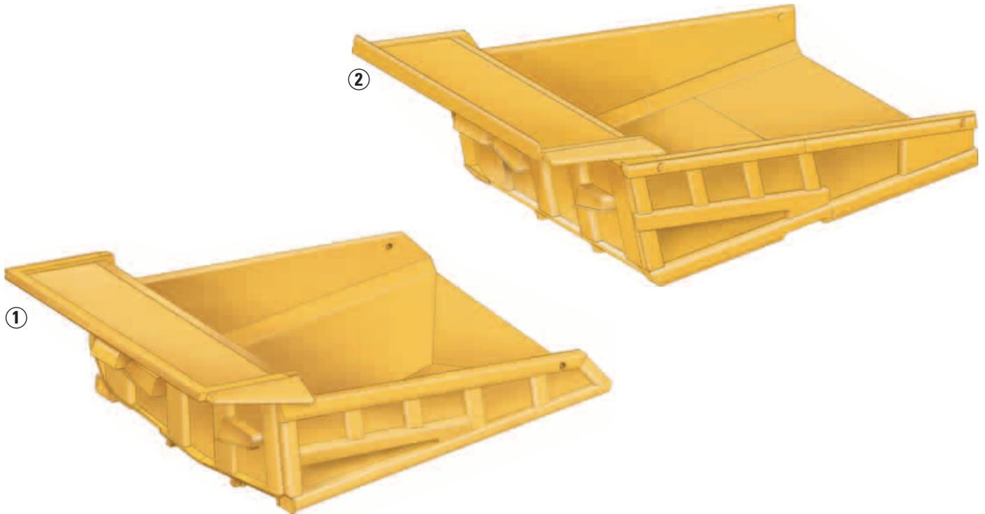
**Teambildung.** Die Kippmulden des 773E sind in Form und Fassungsvermögen bestens auf Cat Radlader und Hydraulikbagger bei Materialschüttgewichten ab 1,7 t/m<sup>3</sup> abgestimmt. Daher lässt sich für jeden Einsatzfall problemlos das geeignete Maschinenteam zusammenstellen.
