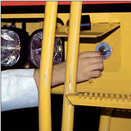
**Batterie Hauptschalter.** Der Schalter wurde bodennah angeordnet, damit das Bordnetz aus Sicherheitsgründen vor der Durchführung von Servicearbeiten ohne Besteigen der Maschine unterbrochen werden kann.
