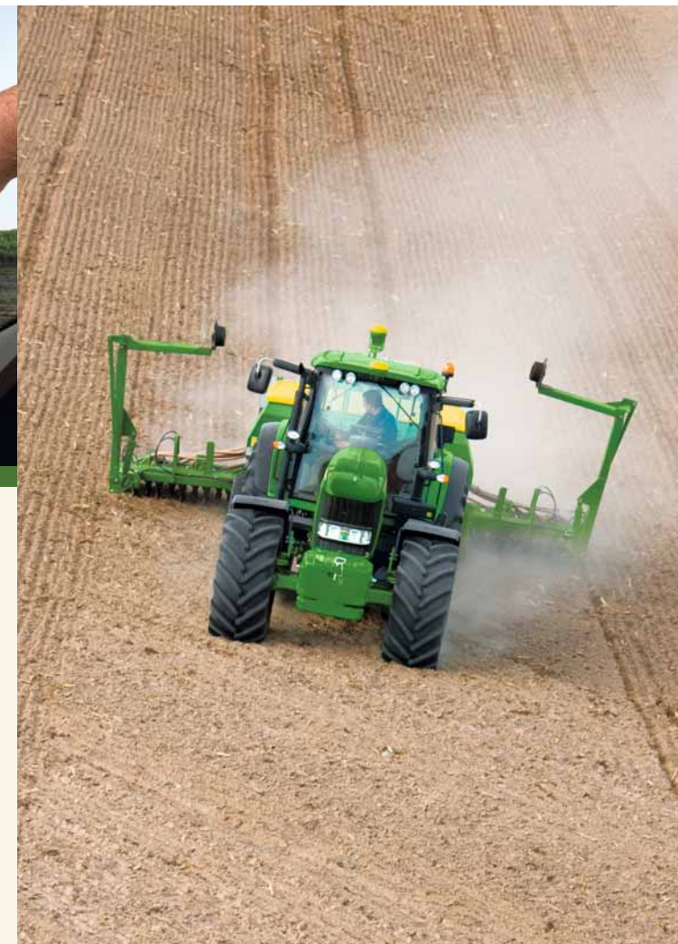
L'innovativo sistema iGuide mantiene le seminatrici 750A in posizione, garantendo risultati ottimali in curve e pendenze.
