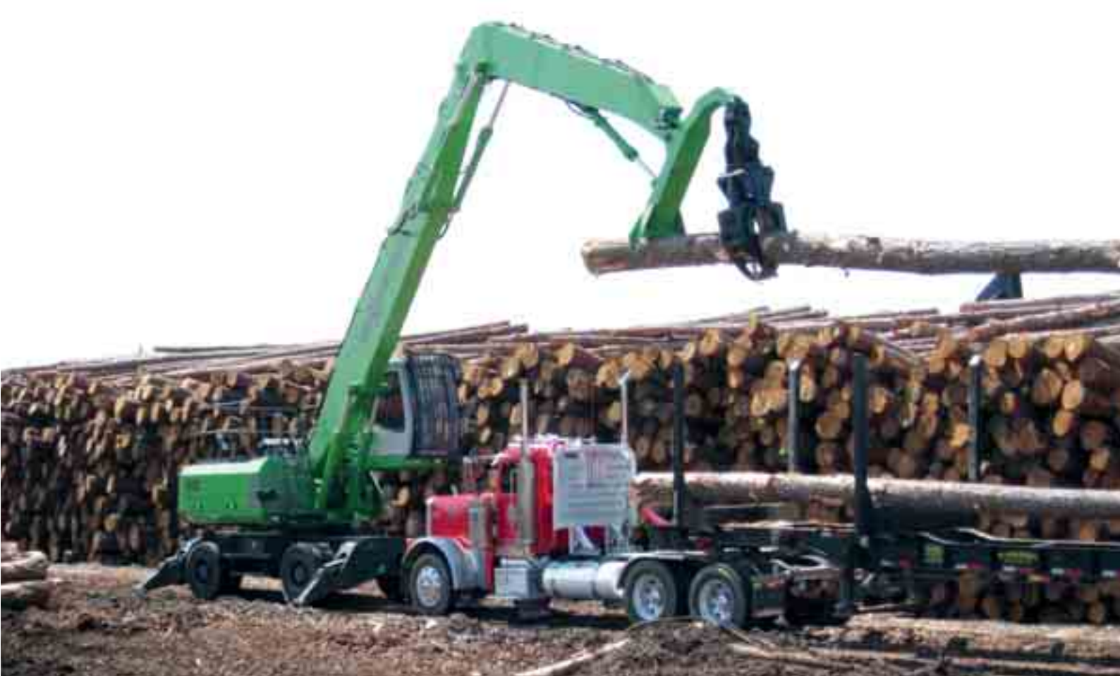
830 M - manipulación de troncos de madera largos con grapa forestal Live Heel (consultar disponibilidad); EUA 830 M – перевалка длинного леса с использованием захвата для круглого леса Live Heel (по запросу); США
