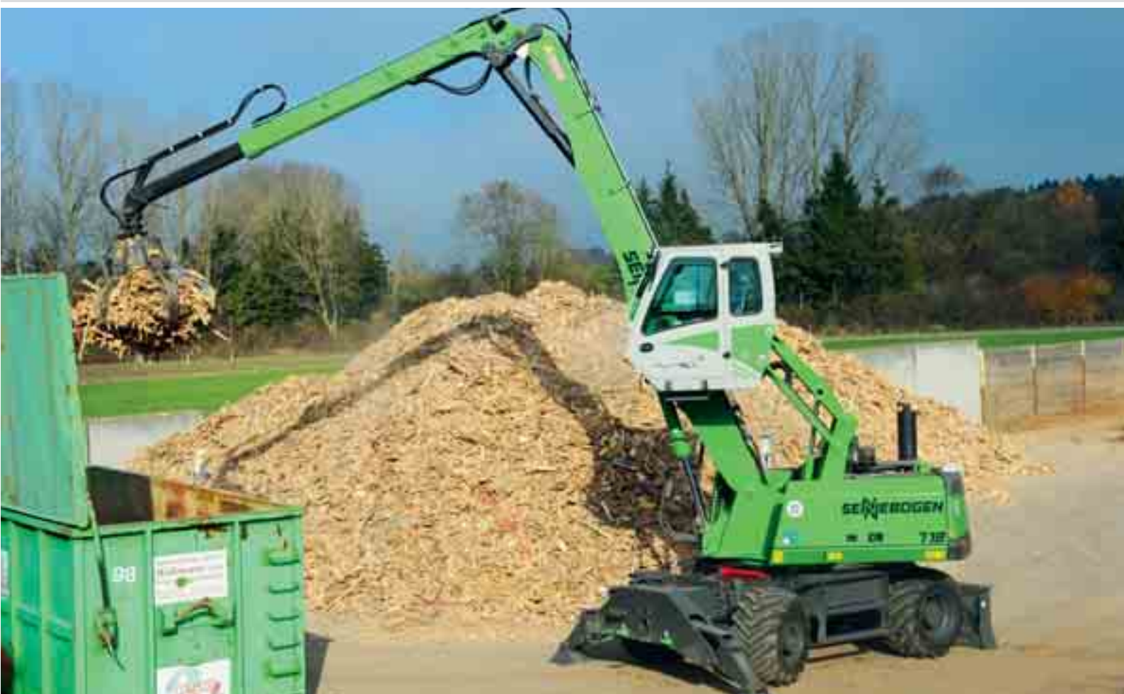
718 – tareas de carga de madera vieja desmenuzada con el pulpo para chatarra; Alemania
