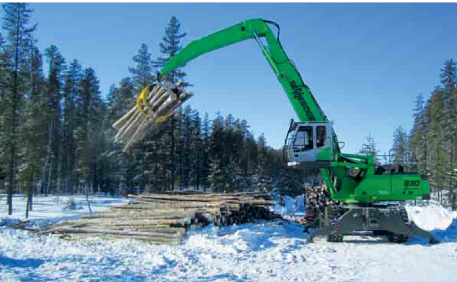
830 M-Trailer – toma de troncos de madera en zonas forestales con tráiler para un mayor volumen de transporte; Canadá 830 M-Trailer – захват круглого леса на месте заготовки, с прицепом для большего объема транспортировки; Канада
