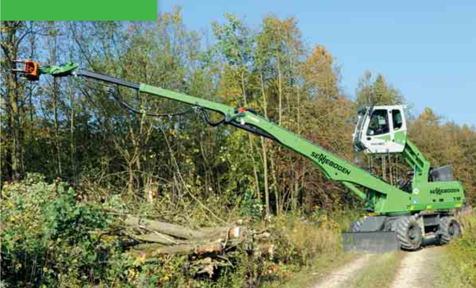
718 - limpieza segura de caminos gracias al amplio alcance de 13 m con cabezal de corte; Alemania
