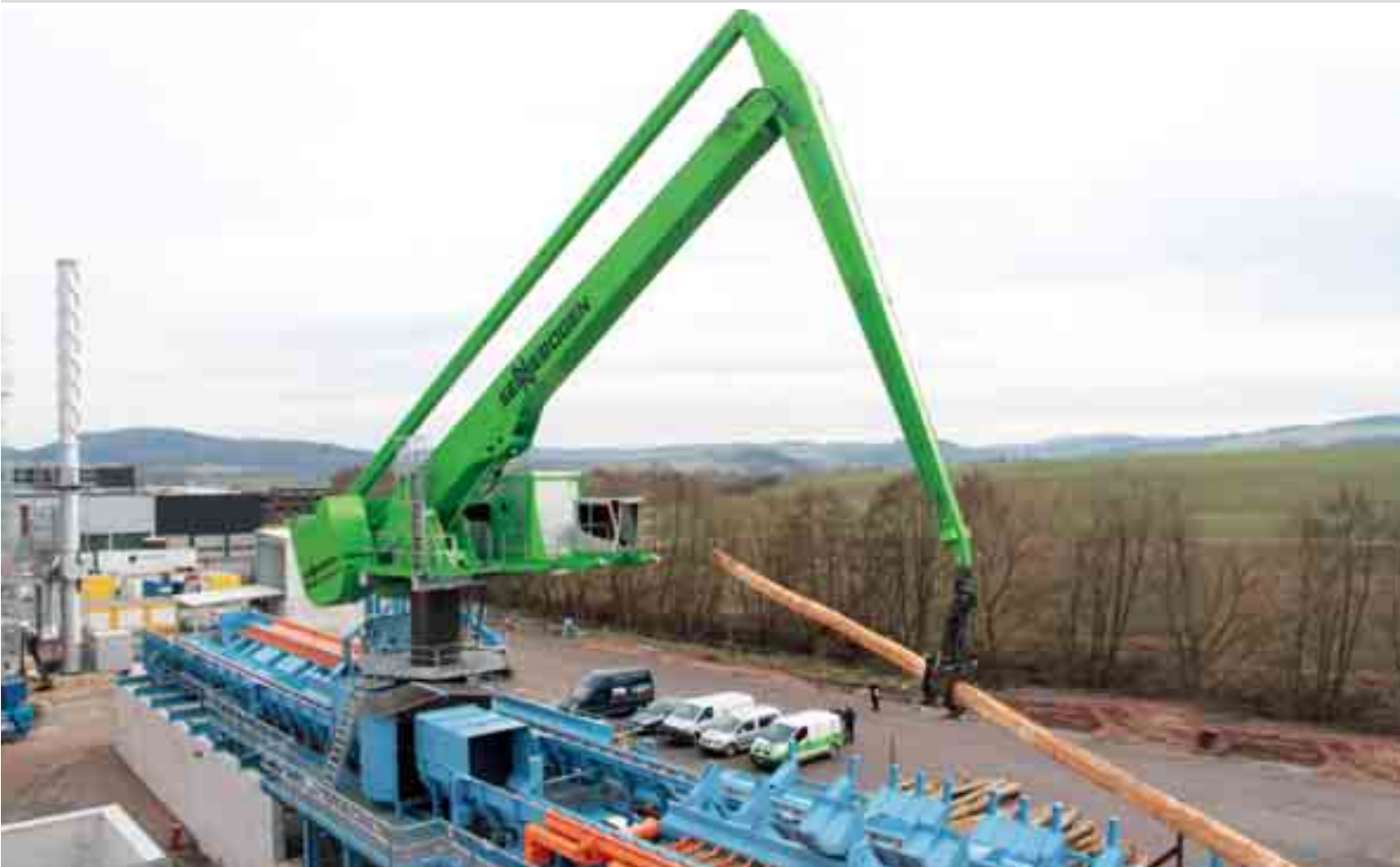
8130 Balancer - manipulación de troncos de madera largos para la fabricación especial de chapas de madera
