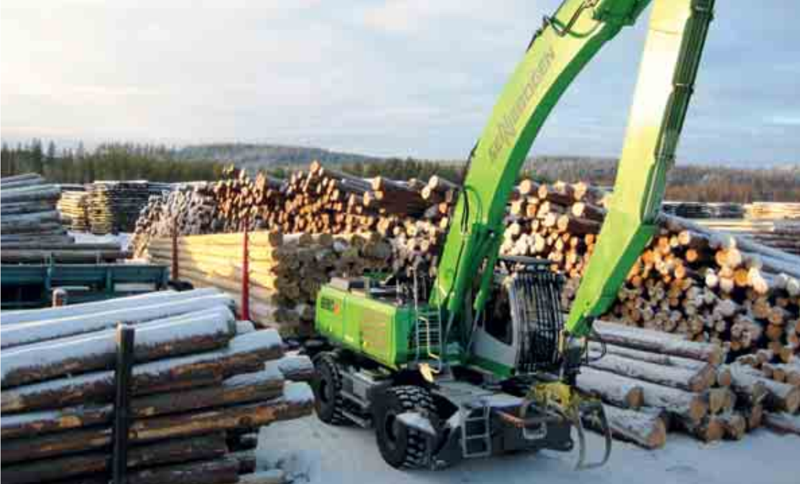
830 M-Trailer - enorme fuerza de tracción para mover tráileres de hasta 80 t de peso; Finlandia 830 M-Trailer – невероятная тяга позволяет перевозить прицеп массой до 80 т; Финляндия
