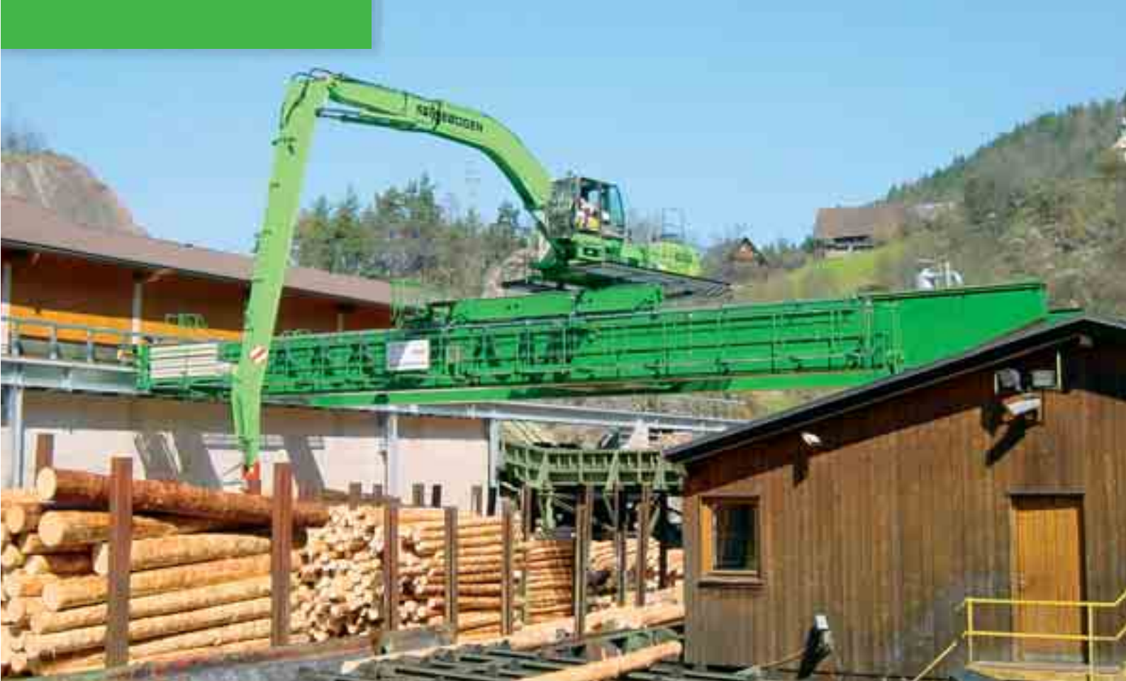
835 con motor eléctrico - máquina montada sobre carro y semipórtico para conseguir una logística de almacén efectiva; Alemania 835 Elektro – установленная машина на тележке и полупортале для наиболее эффективной логистики склада; Германия
