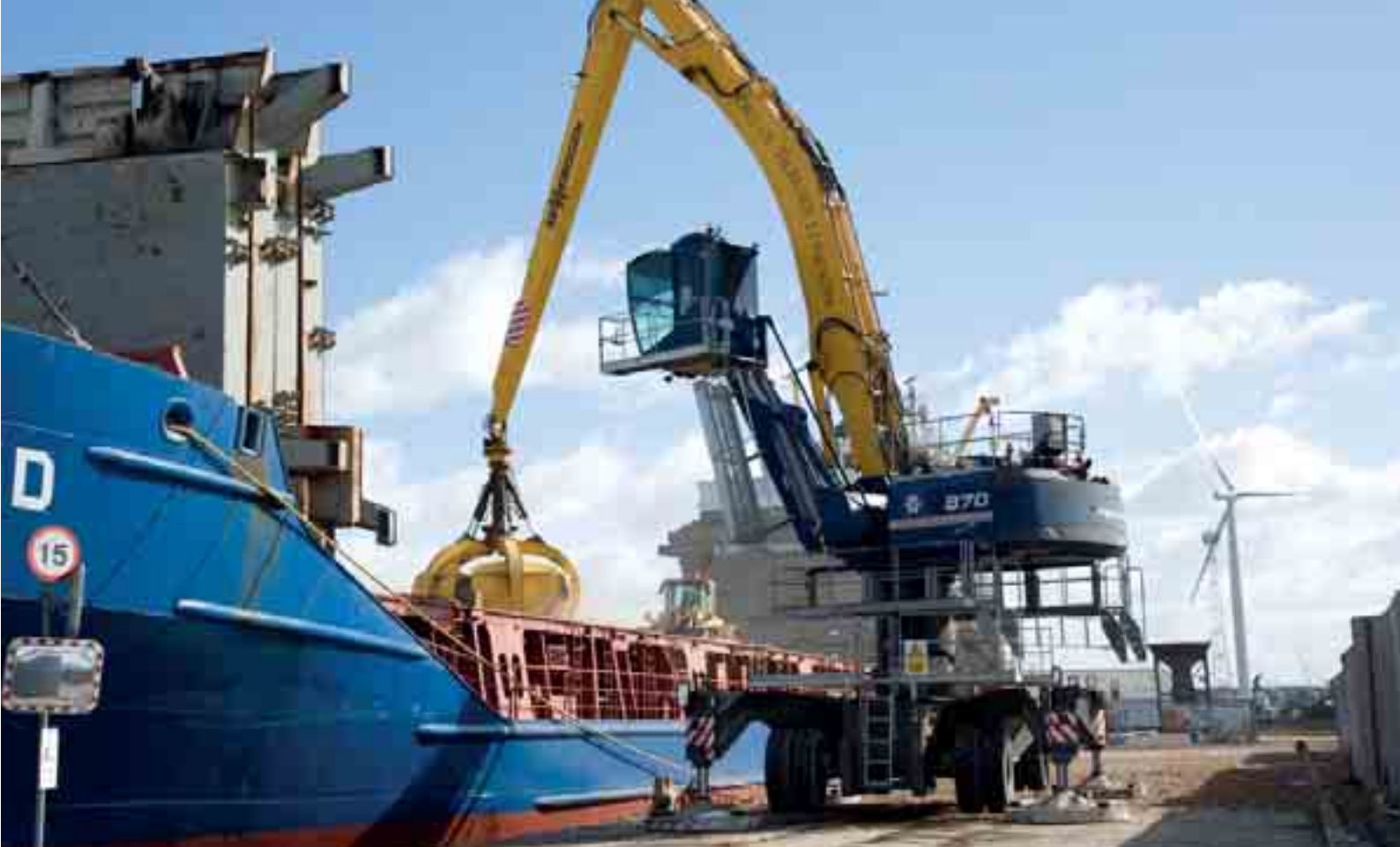
870 M - carro inferior extraordinariamente estable para la manipulación de madera troceada de gran volumen, Mastercab con elevación de cabina Skylift; Inglaterra 870 M – чрезвычайно стабильная ходовая часть для погрузки щепы грейфером большого объема, кабина Mastercab с системой подъема skylift;
