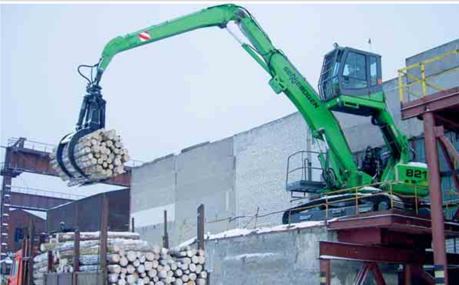
821 con motor eléctrico - alimentación de madera en la línea de procesamiento de una fábrica de papel; Rusia 821 Elektro – загрузка леса на бумажной фабрике; Россия
