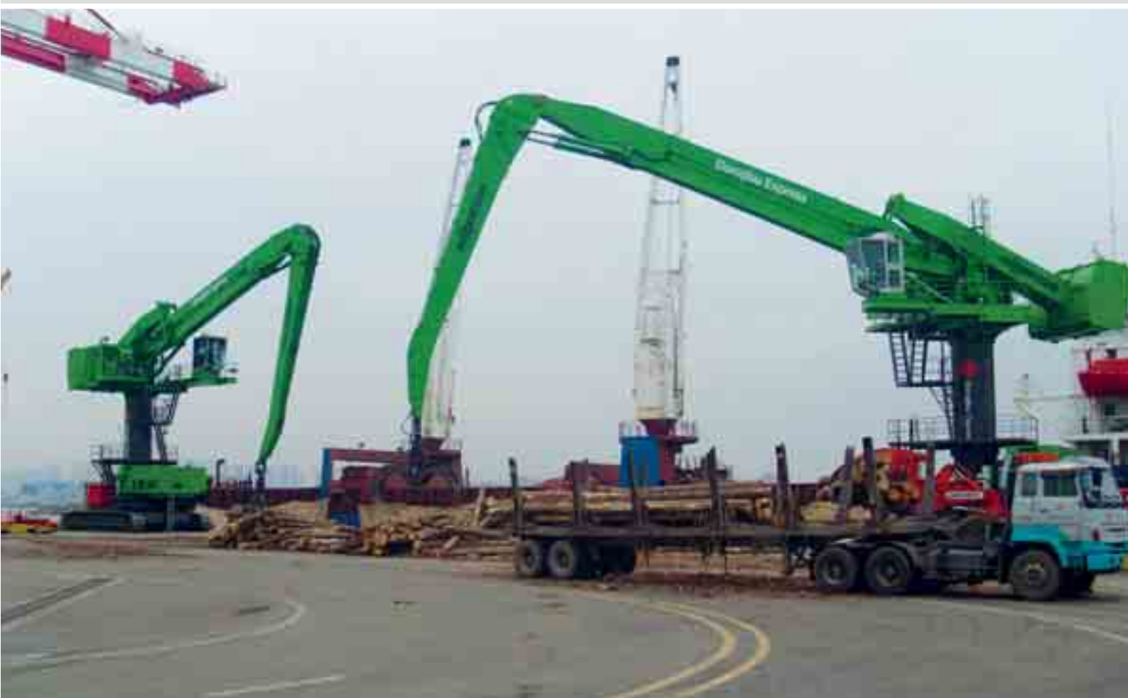
880 EQ - 2 máquinas con pilón y carro inferior sobre orugas, accionamiento eléctrico y Powerpack para el desplazamiento autónomo; Corea del Sur 880 EQ – 2 машины с пилоном и гусеничной ходовой частью, электроприводом и блоком питания для автономного перемещения; Южная Корея
