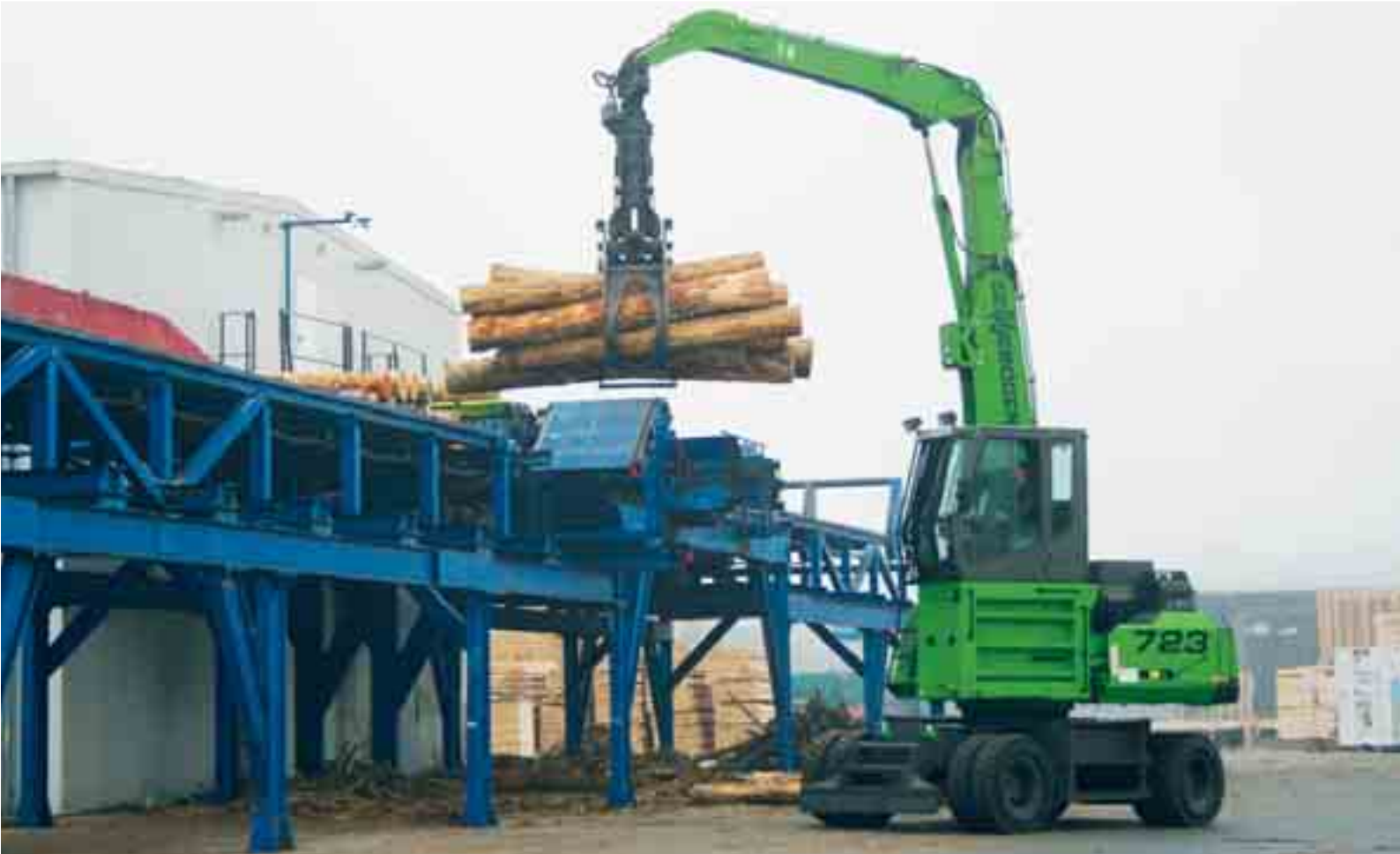
723 M-HD – alimentación de troncos de madera en una plataforma de carga elevada 723 M-HD – погрузка круглого леса на высокий подающий стол
