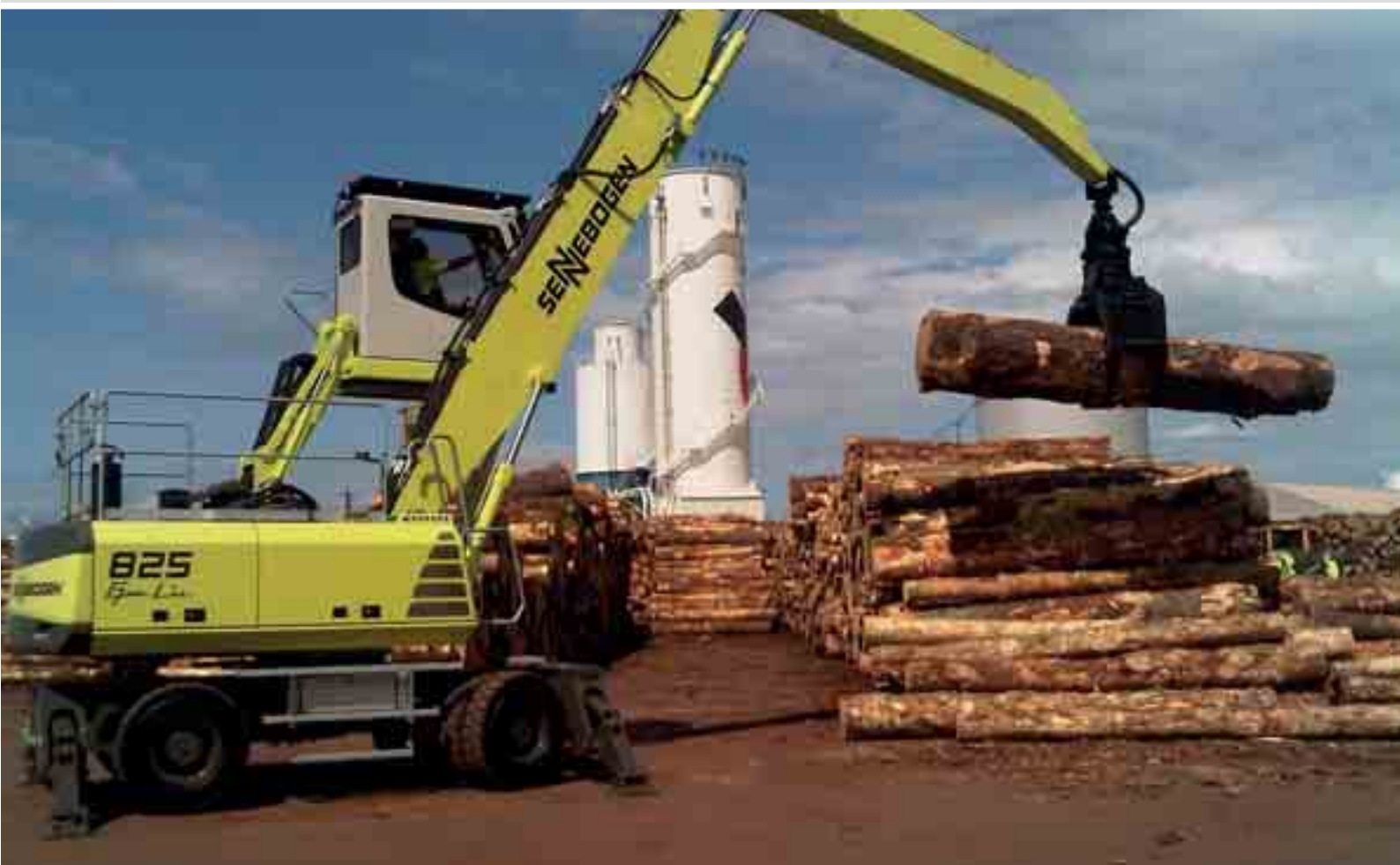
825 M – máquina manipuladora estándar utilizada para desempeñar diferentes tareas en un parque de madera; Australia 825 M – стандартная перевалочная машина для различных задач на складе древесины; Австралия
