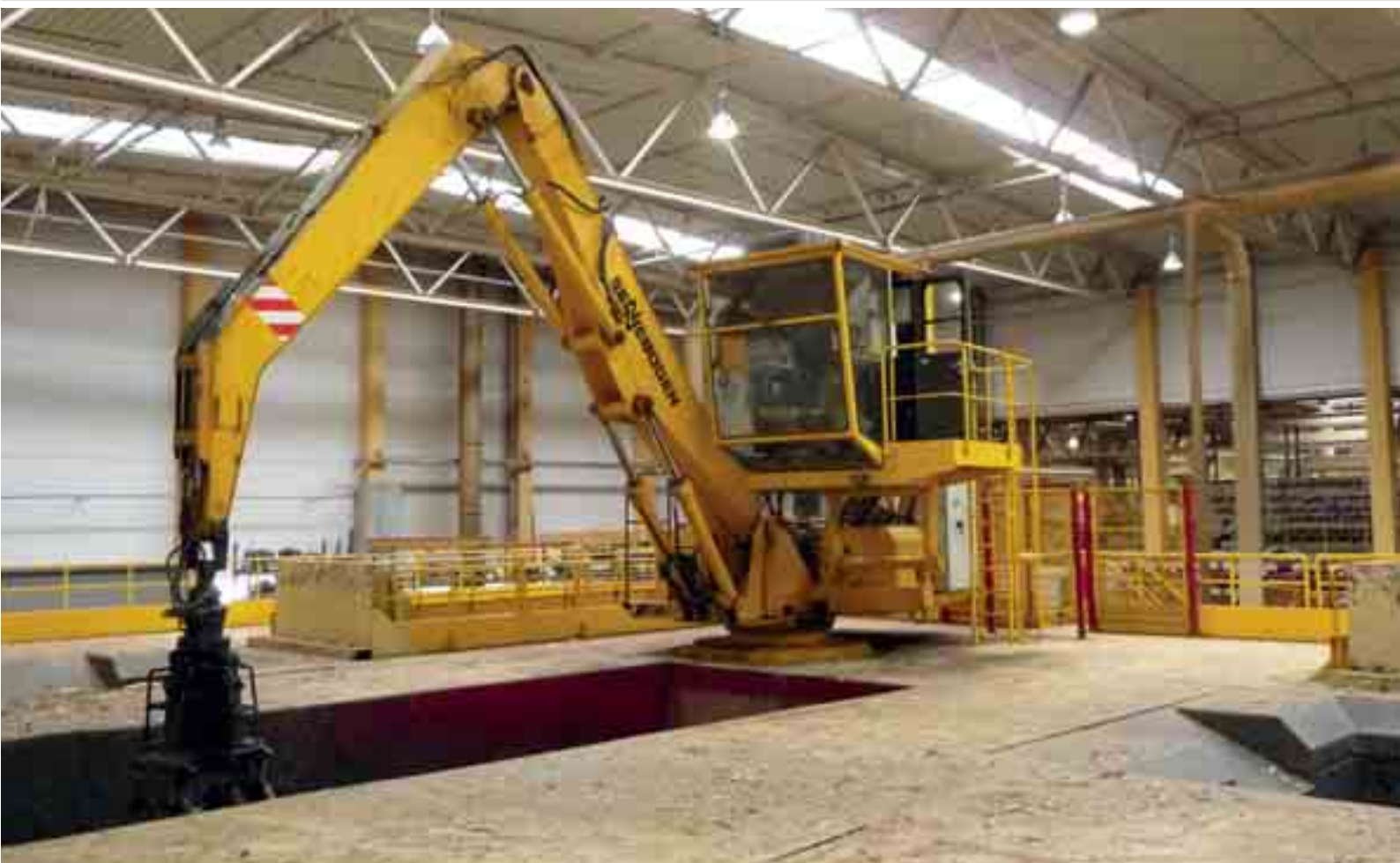
835 con motor eléctrico - máquina estacionaria alimentando la línea de procesamiento con más de 100 000 horas de servicio; Alemania 835 Elektro – стационарная машина в производственном процессе с наработкой более 100 000 моточасов; Германия
