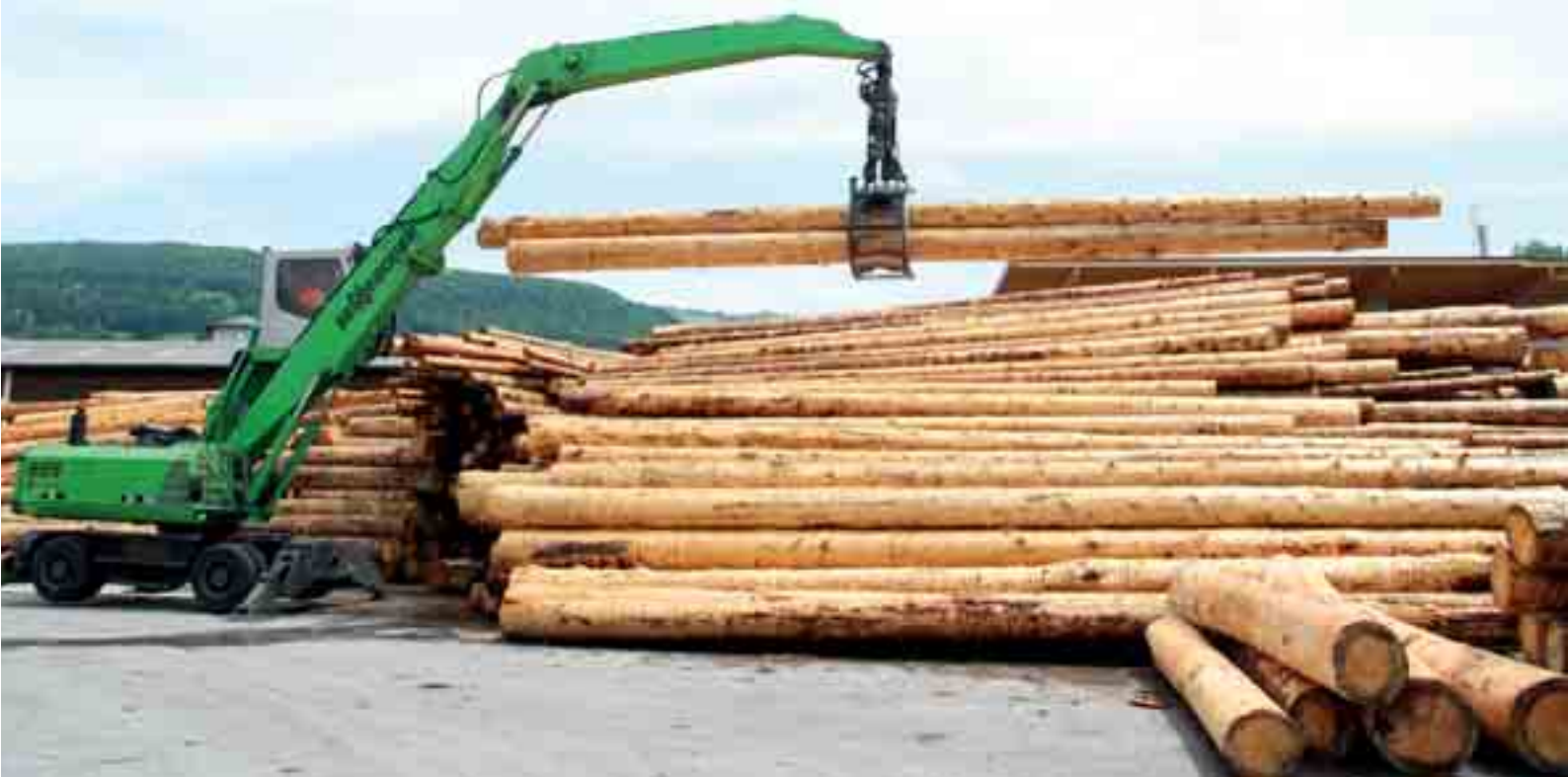
825 M – máquina manipuladora estándar utilizada para desempeñar diferentes tareas en un parque de madera; Austria 825 M – стандартная перевалочная машина для различных задач на складе древесины; Австрия
