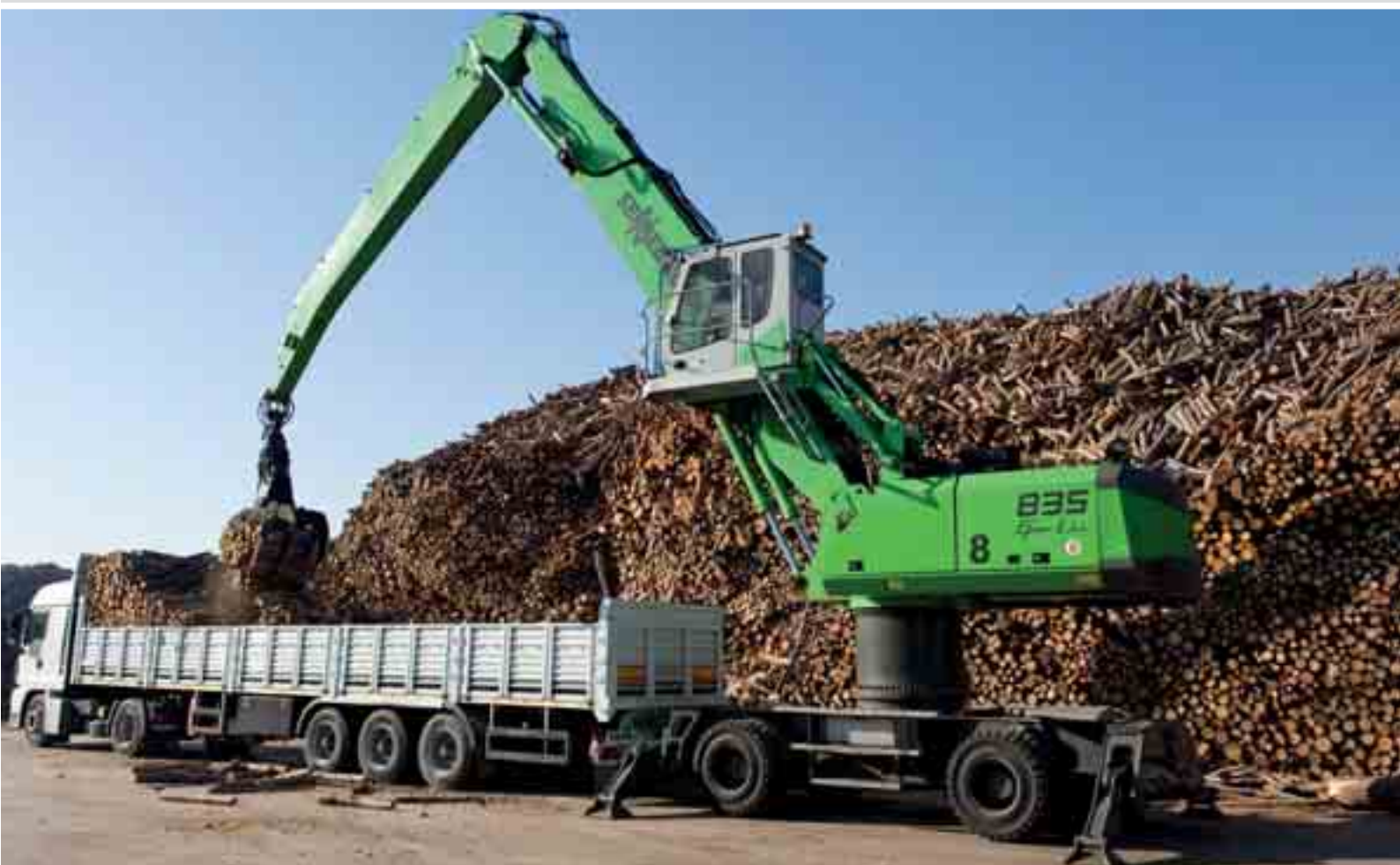
835 M - el alcance de 18 m y el pilón elevado 1,5 m ofrecen una enorme área de trabajo; Turquía 835 M – невероятно большой рабочий диапазон благодаря вылету стрелы 18 м и 1,5 м пилону; Турция
