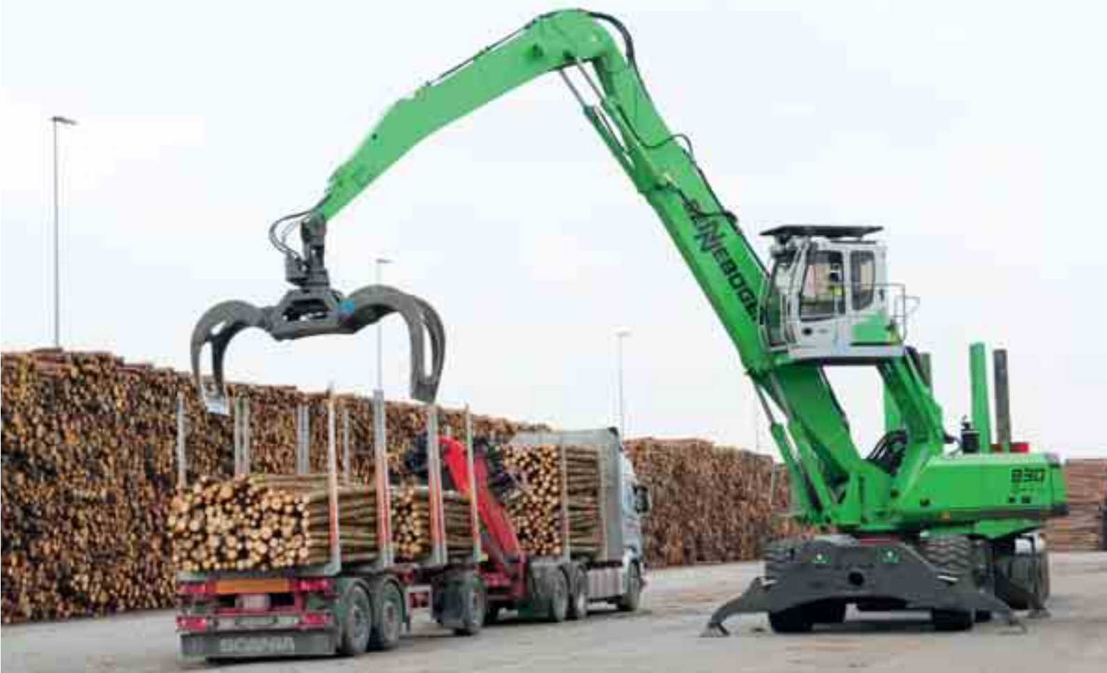
830 M-Trailer - carga y descarga rápida de camiones gracias a la gran capacidad del pulpo; Alemania 830 M-Trailer – быстрая погрузка и разгрузка автопоезда благодаря большой вместимости грейфера; Германия
