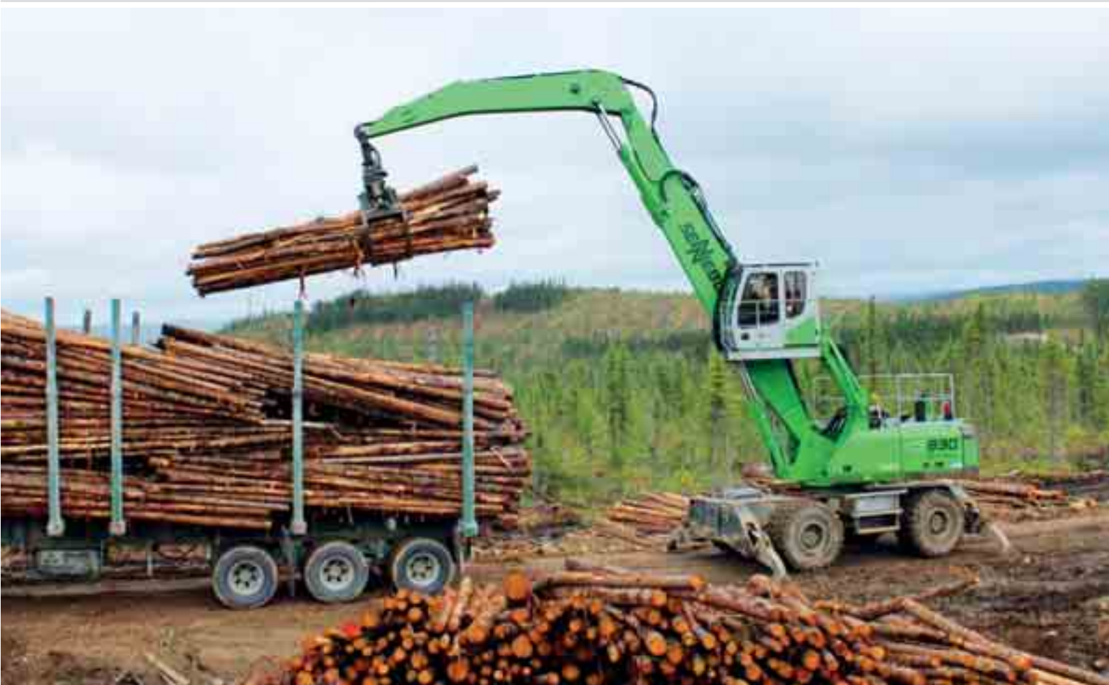
830 M-Trailer – carga de camiones por la parte trasera gracias a su amplio alcance; Canadá 830 M-Trailer – погрузка в грузовик через задние стойки благодаря большому вылету стрелы; Канада
