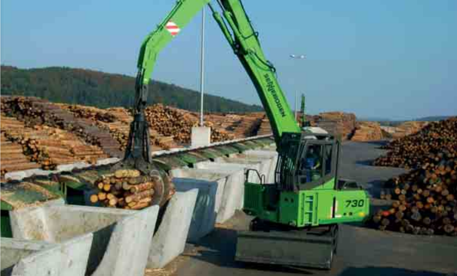
730 M-HD – toma de los troncos de madera en la línea de clasificación de forma paralela al sentido de la marcha 730 M-HD – захват круглого леса с сортировочной линии, проходящей параллельно полосе движения
