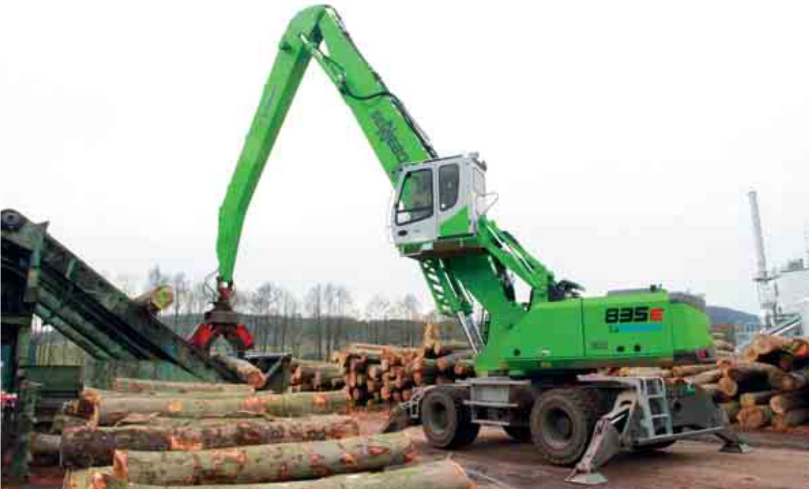
835 M - alimentación de la plataforma de carga para la línea de procesamiento 835 M – загрузка подающего стола в производственном процессе
