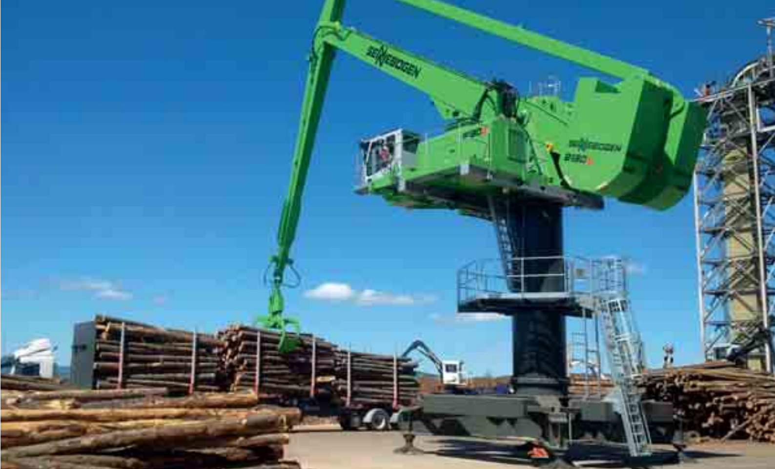
8130 Balancer estacionaria - manipulación de troncos de madera, descarga de camiones, alimentación de la planta de procesamiento; Australia
