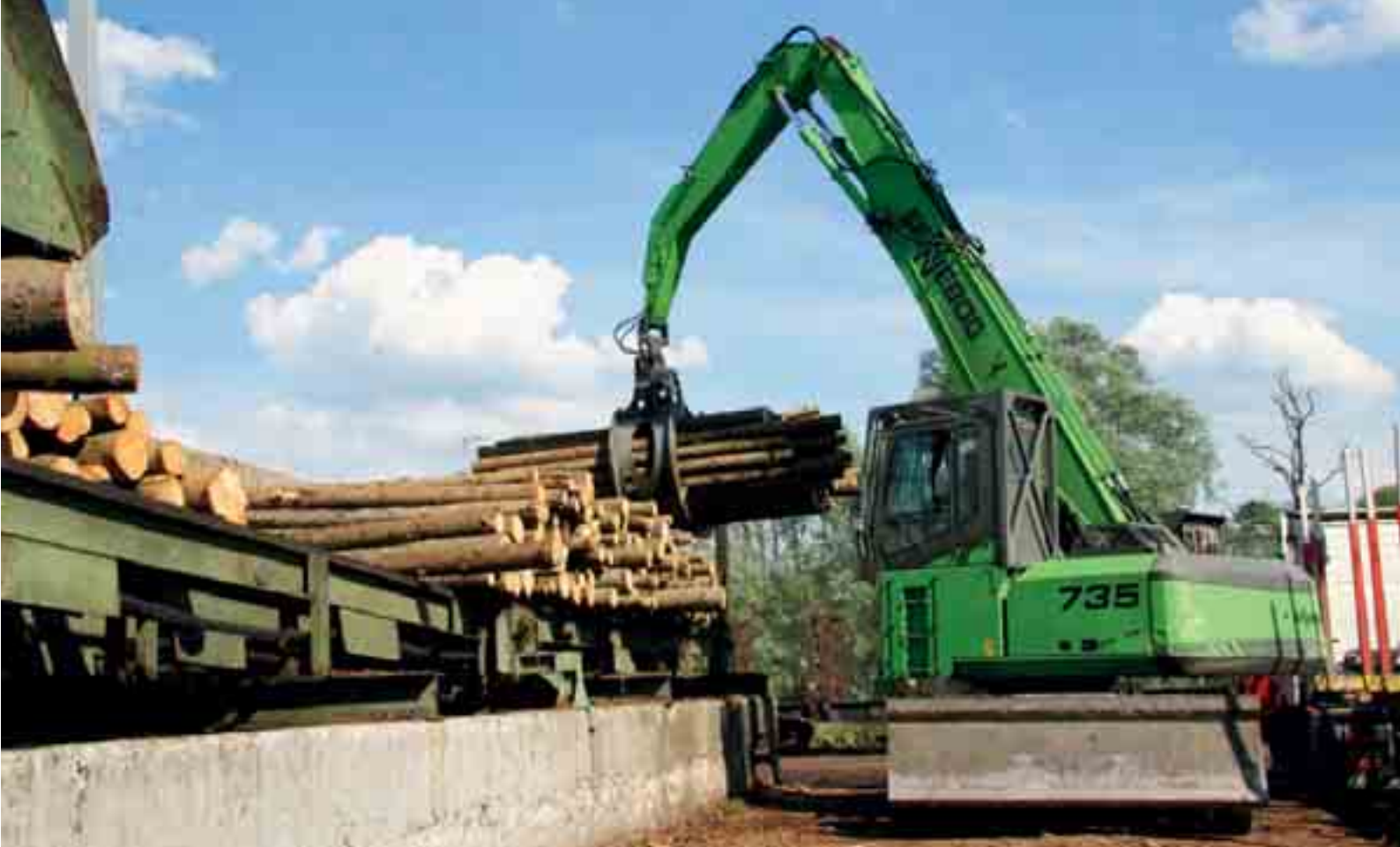
735 M-HD – carga de la plataforma de carga directamente desde el camión en vías estrechas 735 M-HD – погрузка на подающий стол напрямую с грузовика в узком проезде
