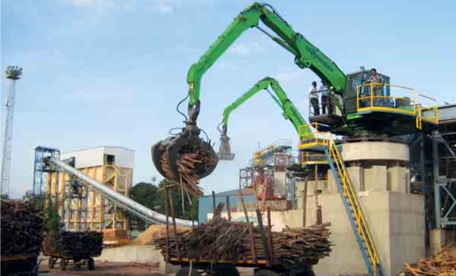
821 A con motor eléctrico - máquina estacionaria con cojinete elástico alimentando la línea de procesamiento; India 821 A Elektro – стационарная машина с эластичной опорой в производственном процессе; Индия
