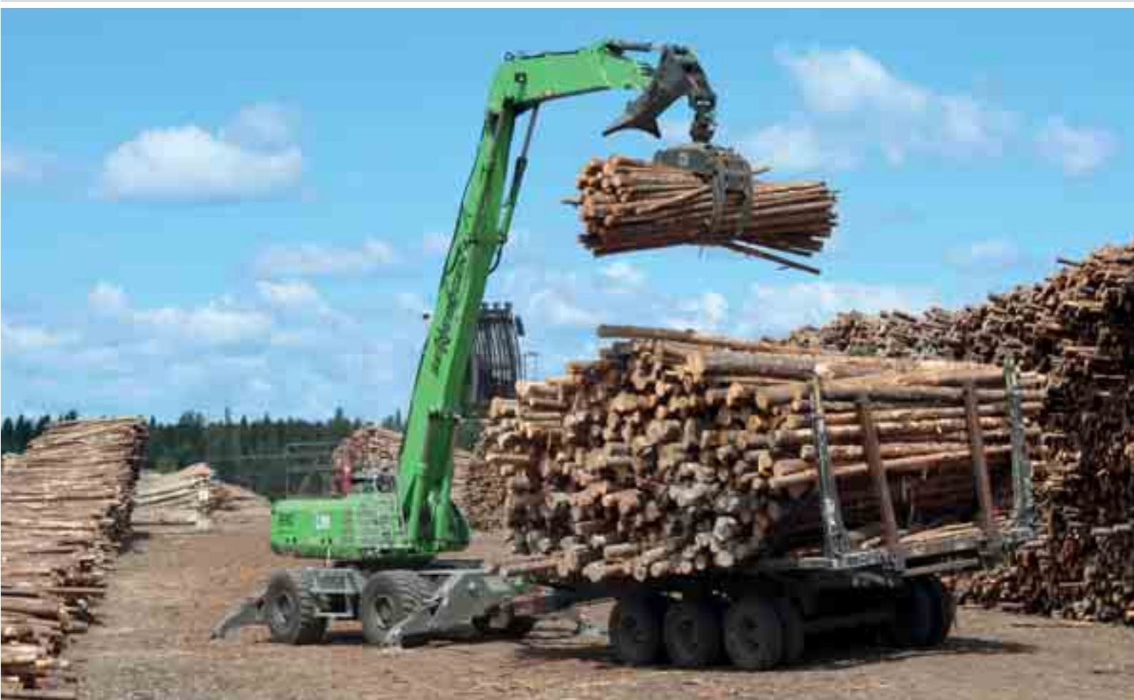
26 830 M-Trailer – pulpo especial para la manipulación de troncos de madera cortos y largos; Canadá 830 M-Trailer – специальные грейферы для перевалки короткого и длинного леса; Канада
