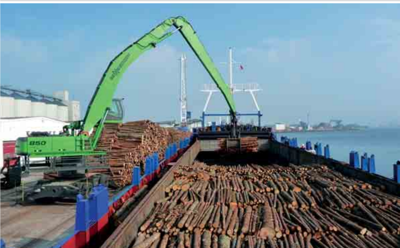
850 M - descarga efectiva de un buque con un alcance de 20 m y pilón elevado 1,5 m; Alemania 850 M – эффективная разгрузка судна благодаря вылету стрелы 20 м и пилону 1,5 м; Германия
