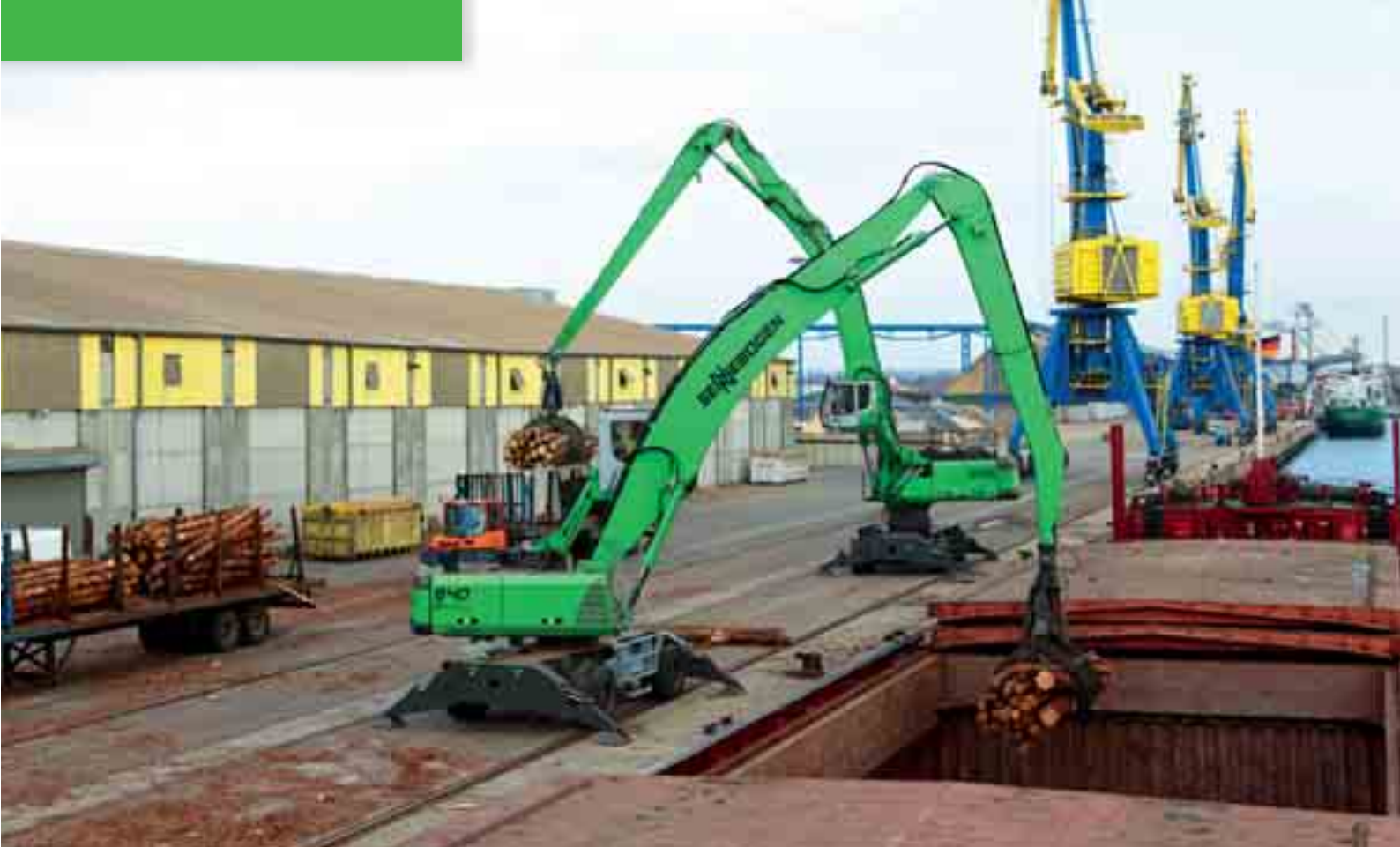
840 M y 870 M - carga paralela de un carguero de tamaño medio con equipamiento largo; Alemania 840 M и 870 M – параллельная погрузка на грузовое судно средней величины при помощи удлиненных стрел; Германия
