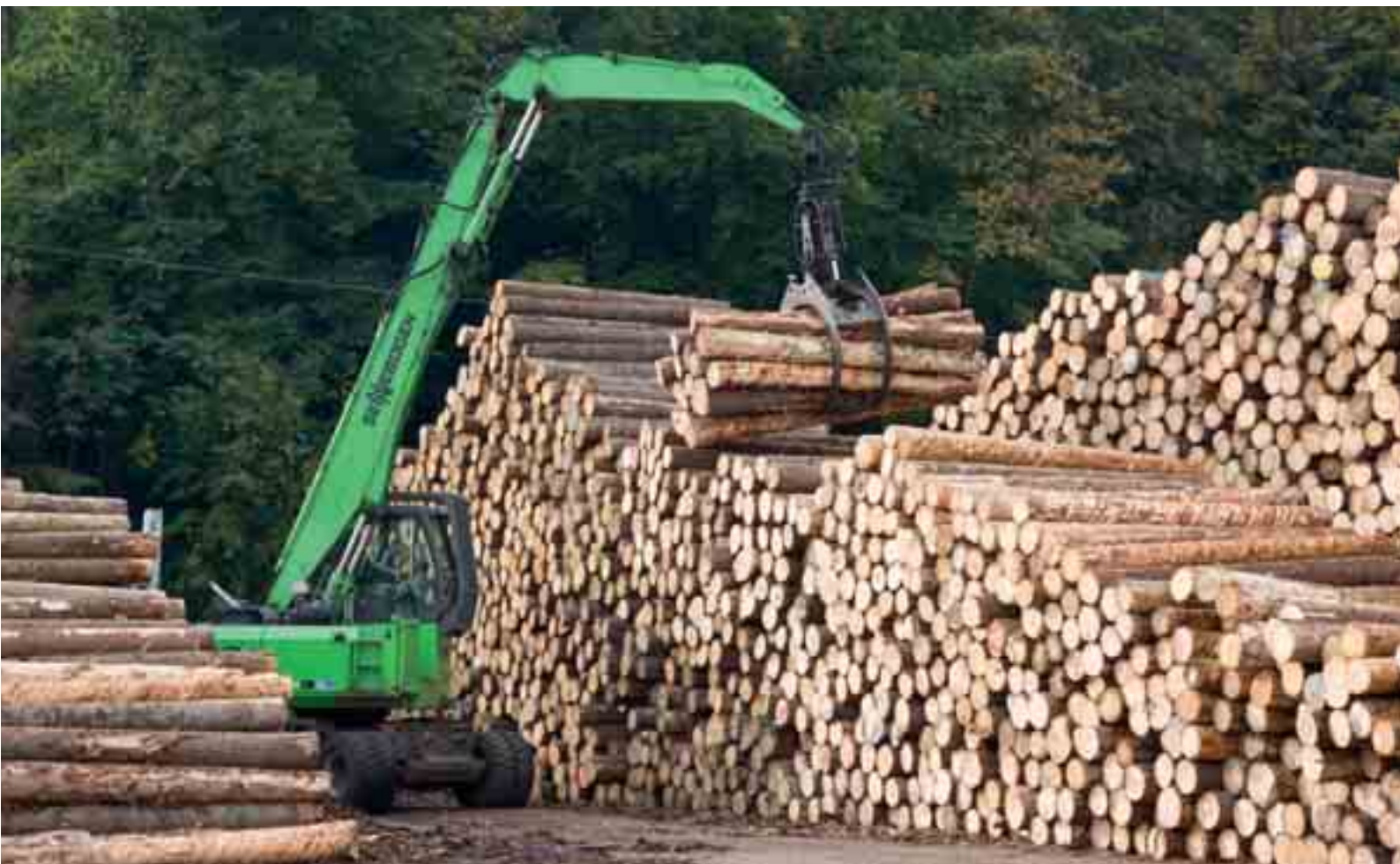
735 M-HD – con una máquina Pick & Carry se alcanzan alturas de apilado de hasta 10 m 735 M-HD – позволяет достичь высоты штабелирования 10м благодаря концепции Pick&Carry (Перевалка и Перевозка)
