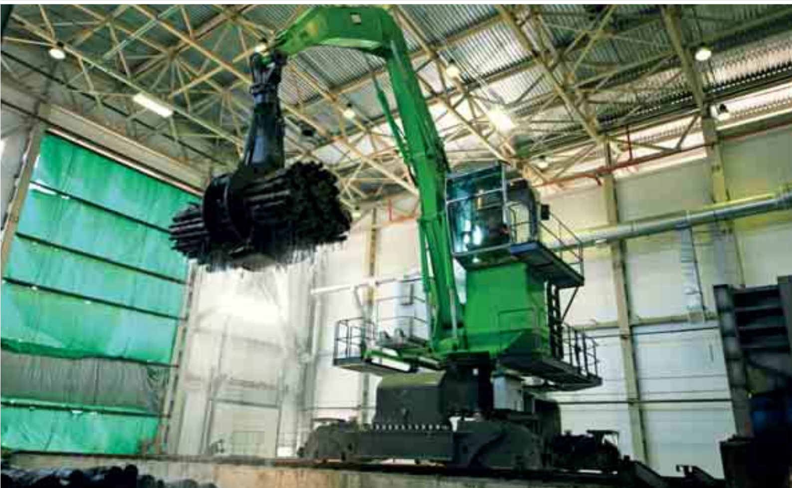
835 con motor eléctrico - máquina con carro de rodadura sobre carriles y suministro eléctrico mediante carriles conductores en la línea de procesamiento; Rusia 835 Elektro – машина на железнодорожном шасси и питанием по контактными рельсам в производственном процессе; Россия
