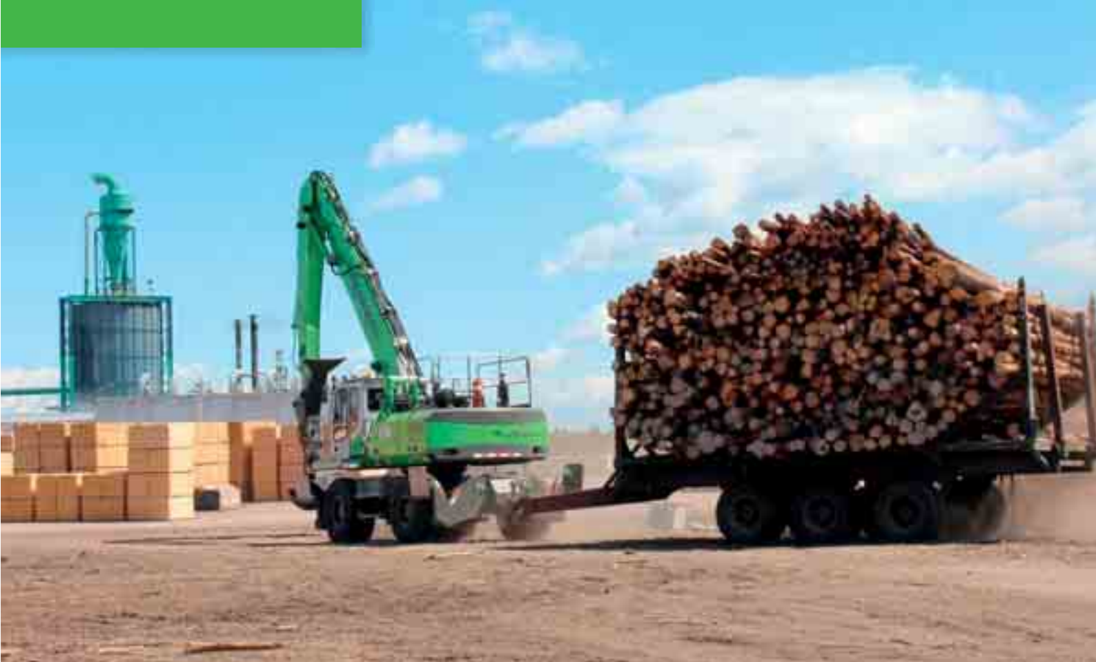
830 M-Trailer – excelente capacidad de marcha sobre todo tipo de terreno gracias a sus grandes neumáticos 650/65-R25 y a los potentes accionamientos de traslación; Canadá 830 M-Trailer – высокая проходимость благодаря большому диаметру шин 650/65-R25 и мощному приводу ходовой части; Канада
