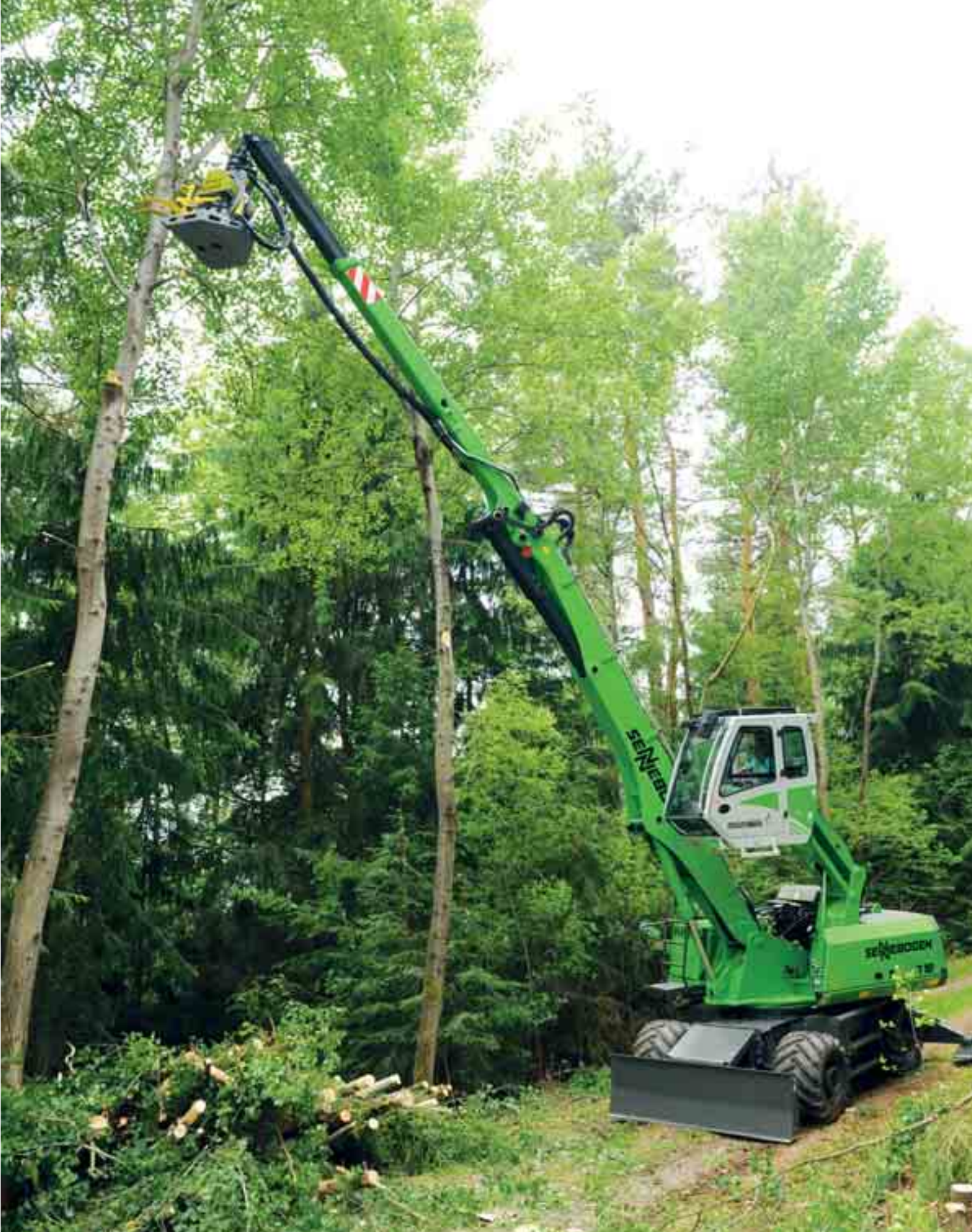
718 - extracción gradual de árboles problemáticos con el colector; Alemania
