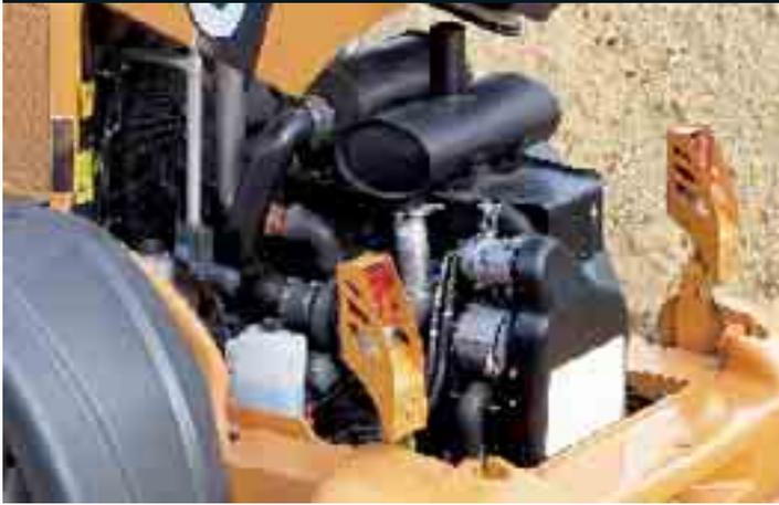
La 721E et la 821E sont équipées d'un moteur diesel Case 667TA/EED Tier III.
