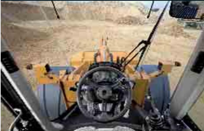
Les modèles 721E et 821E bénéficient d'une cabine ergonomique beaucoup plus grande que celle des machines de la série D. Les vitres avant et latérales montent du sol jusqu'au plafond. Elles sont sans montant et offrent une visibilité exceptionnelle sur le godet ou l'équipement utilisé.
