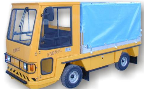
Zur optimalen Abstimmung auf die Einsatzbedingungen können die Geschwindigkeit und die Zugleistung im Rahmen der beiden angegebenen Grenzwerte programmiert werden. Bei Verwendung des Plattformwagens als Schlepper ist bei Gefällestrrecken auf eine ausreichende Beladung des Zugfahrzeuges zu achten. Vor Freigabe ist die Sicherheit durch Testfahrten zu überprüfen. Ansonsten ist die Verwendung einer durchgehenden Bremsanlage zu empfehlen.
