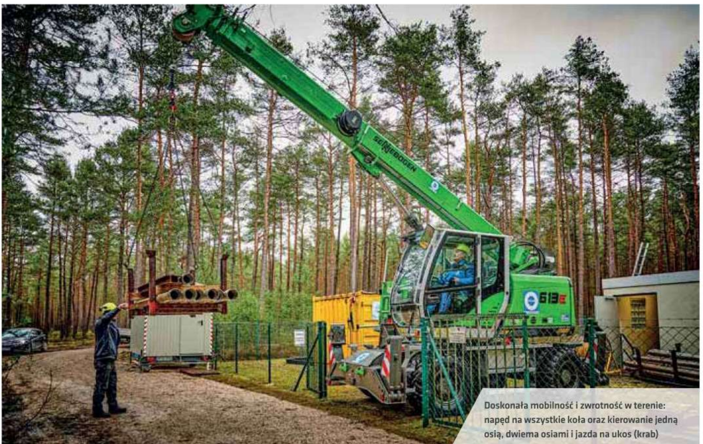
Wysoka stateczność przy kompaktowym rozstawie podpór 4 m x 4,35 m
