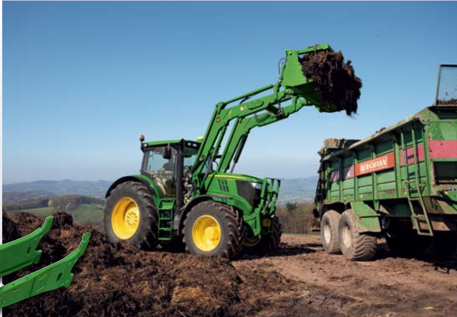
Le châssis intégral autorise le levage et le transport de lourdes charges.
