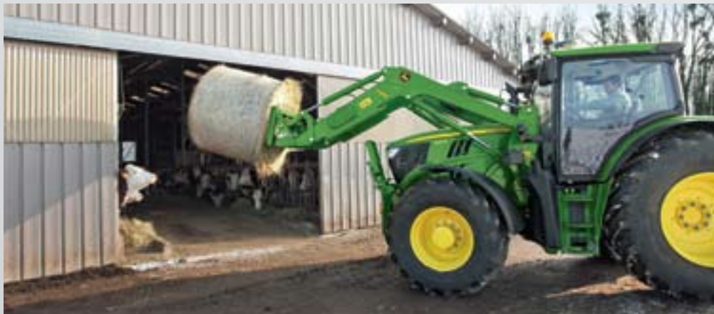
Los modelos H340 y H360 son ideales para trabajos de carga continuados. La capacidad de elevación de la H360 es de hasta 2 t a una altura de 4,4 m.*
