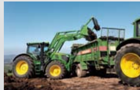
El modelo H380 está diseñado para soportar muchos años de trabajos con cargas pesadas. Tiene una capacidad de elevación de hasta 2,15 t a una altura de 4,5 m.*
