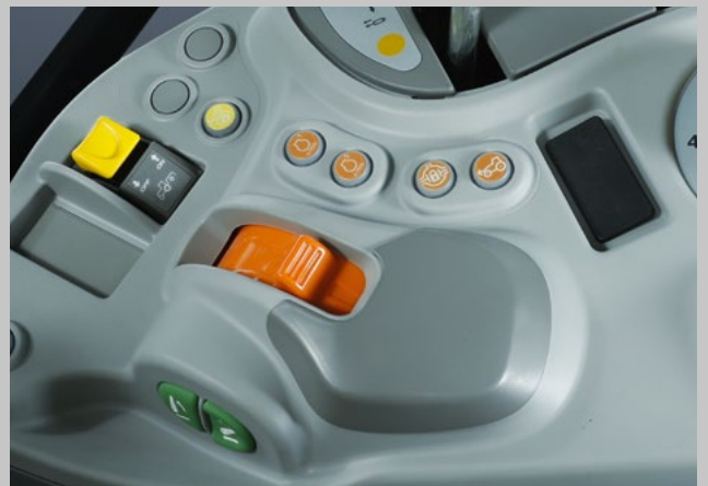
Zwei Motordrehzahlsspeicher. Effizienz für Routinearbeiten vorprogrammiert.
