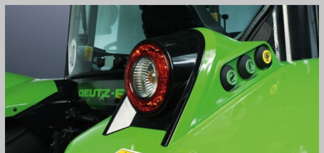
Externe Zapfwellen- und Kraftheberbedienung für leichtes Geräteankoppeln und den externen Gerätebetrieb.
