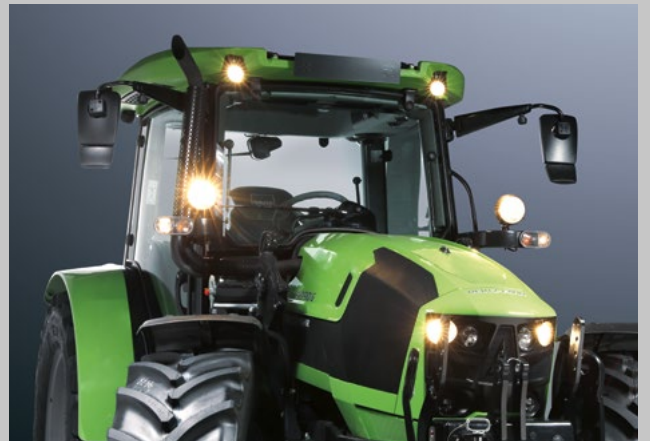
Für beste Sicht bei schlechter Sicht. Sechs Arbeitsscheinwerfer im Dach und an den Seitenholmen. Zwei Arbeitsscheinwerfer in der Motorhaube.
