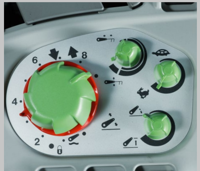
Mechanische oder elektronische Krafthebersteuerung. Sie haben die Wahl.
