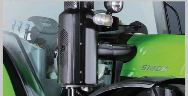
Modernste Abgastechnologie mit DOC (Diesel Oxidationskatalysator, Abgasstufe III B) oder SCR-System (Selektive Katalytische Reduktion, Abgasstufe IV).
