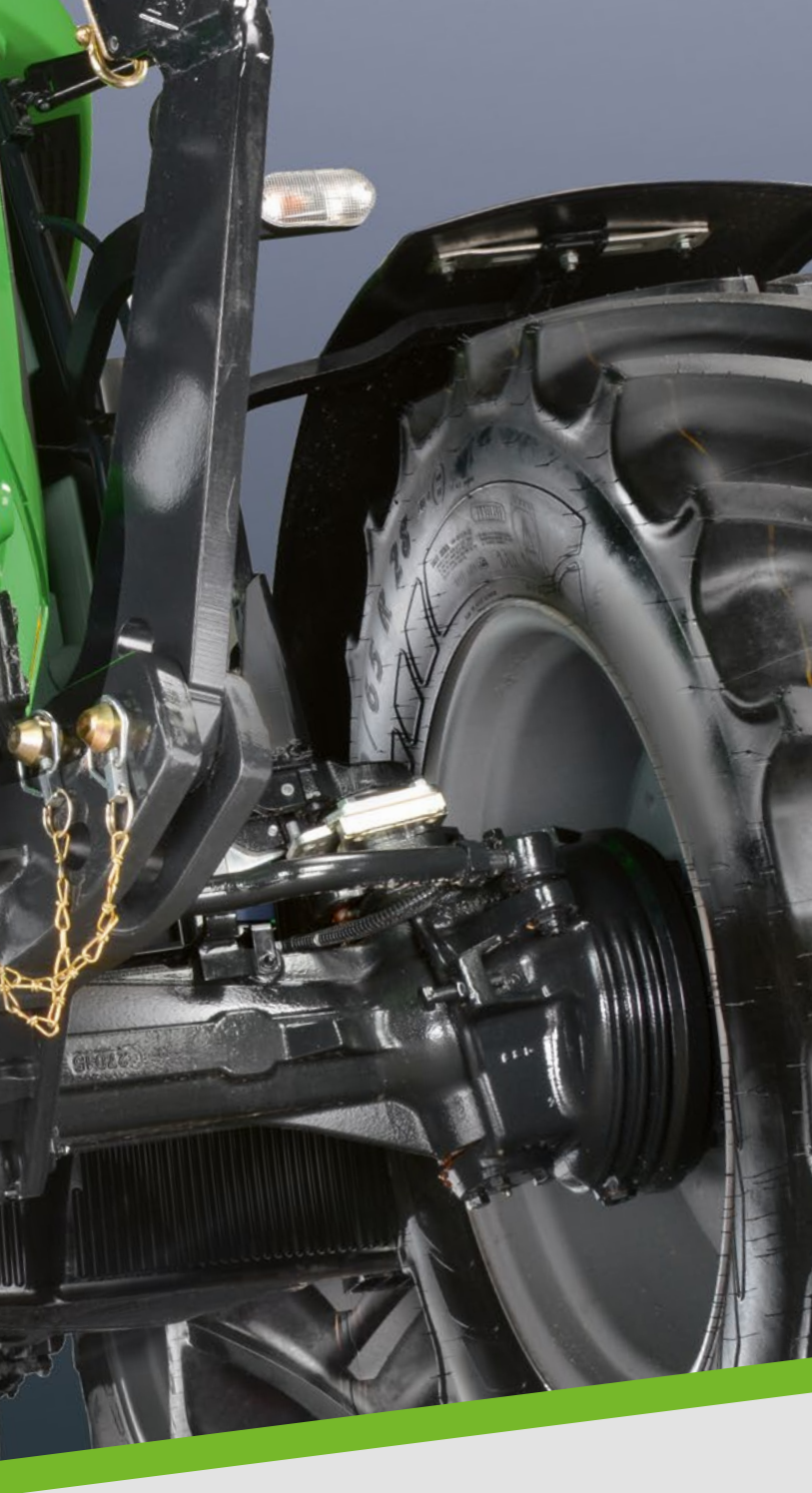
Einzigtiges Sicherheitskonzept von DEUTZ-FAHR. Separate, im Ölbad gekühlte, Scheibenbremsen an den Vorderrädern.
