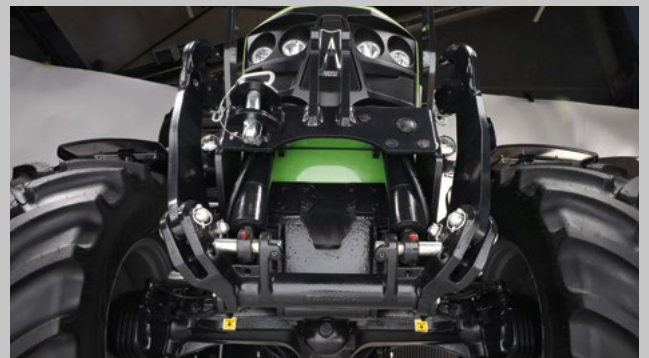
Frontanbauräum. 2100 kg Hubkraft und 1000er Zapfwelle.
