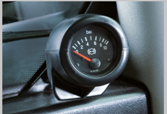
Druckluftbremsanlage (optional) für sicheres Abbremsen von Anbaugeräten.
