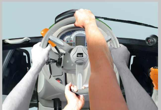
Das SDD Schnelllenksystem. Halbe Lenkraddrehung, doppelter Lenkeinschlag.
