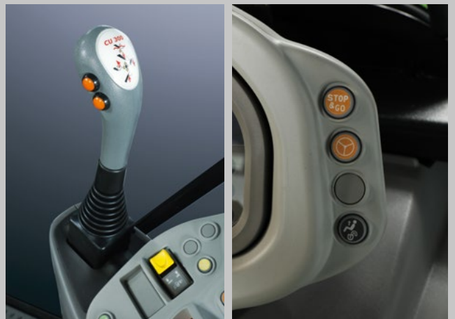
Frontlader-Joystick mit Powershift-Knöpfen, Stop&Go und SDD Schnellensystem und alle...
