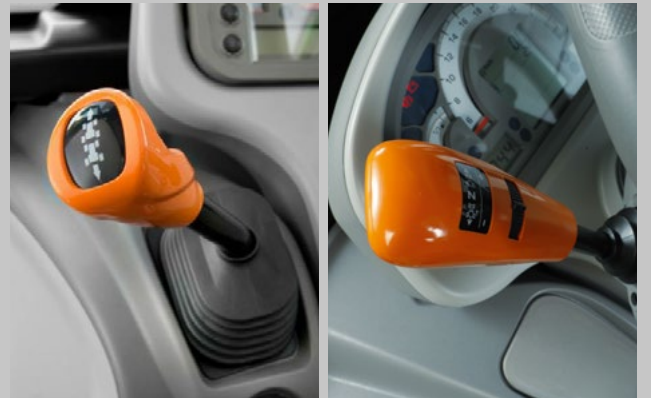
Mechanische oder elektrohydraulische in fünf Stufen einstellbare Wendeschaltung – Sie haben die Wahl.
