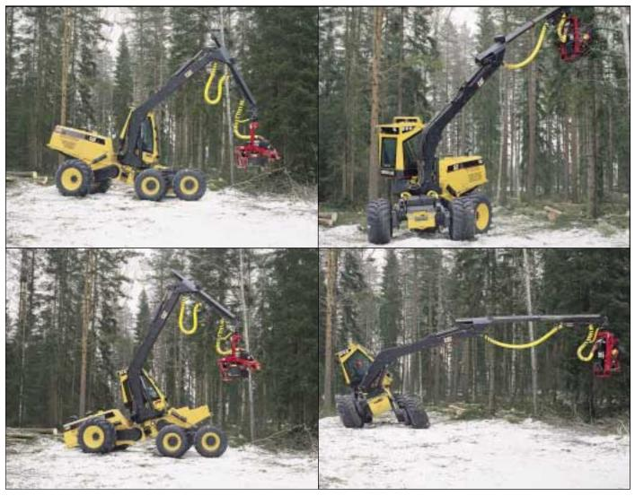
Fahrwerk. Weil die Räder an unabhängig hydraulisch steuerbaren Pendelarmen aufgehängt sind, besitzen Cat Harvester ideale Eigenschaften für eine schonende Durchforstung unter erschwerten Bedingungen.
