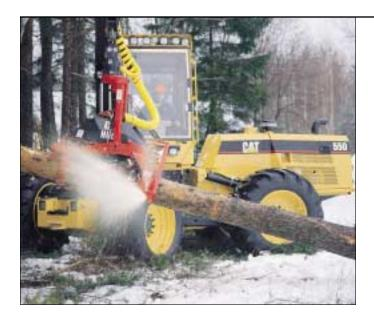
**Anwendung.** Aufgrund kleiner Abmessungen und niedrigen Einsatzgewichts eignet sich der Harvester 550 hauptsächlich für die Durchforstung – bei Bedarf aber auch für Erstdurchforstungen. Speziell bei beengten Platzverhältnissen ist diese solide, vielseitige Maschine in ihrem Element.
