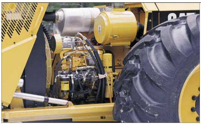
Fahrantrieb. Hydrostatischer Fahrantrieb und Allradantrieb verhelfen den Cat Harvestern zu exzellenter Traktion. Zum Fahrantrieb gehören zwei Hydrostatikkreise mit jeweils einer Fahrpumpe (Fördervolumen 100 cm³) und zwei Fahrmotoren. Durch die Zusammenschaltung (Summenschaltung) beider Pumpen wird eine hohe Straßen-Fahrgeschwindigkeit erreicht, deren Maximalwert sich individuell einstellen läßt.
