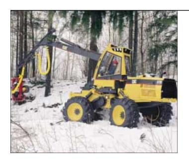
**Anwendung.** Mit dem Harvester 570 steht ein vielseitiger Vollernter zur Verfügung, der sich bei Durchforstung und Endnutzung hervorragend bewährt hat. In seiner kompakten Bauweise entspricht er dem Typ 550, entwickelt aber höhere Kräfte zur Bearbeitung größerer Stämme.
