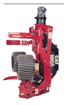
Harvesteraggregat HH55. Dieses Gerät bietet ausreichende Leistung für effektive Endnutzung und zeigt sich dabei leicht und flexibel genug für die Durchforstung. Während der automatische Sägekettenspanner serienmäßig vorhanden ist, kann auf Wunsch eine Überkreuz-Durchmessererfassung geliefert werden.
