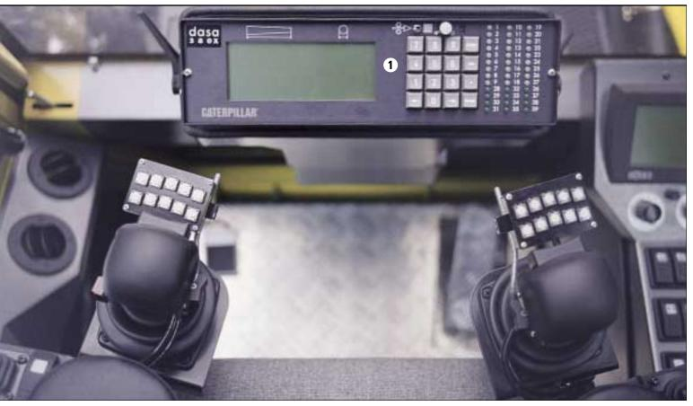
Komfort und Sicherheit. In der zeitgemäß ausgestatteten Kabine mit schwingungsisolierender Befestigung sind alle Bedien- und Kontrollelemente ergonomisch angeordnet. ROPS-, FOPS- und OPS-Zertifizierung garantieren maximale Sicherheit.
