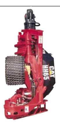
Harvesteraggregat HH65. Ein Mehrzweckgerät mit äußerst robuster Konstruktion für schwere Beanspruchungen. Die Entastungsmesser werden aus hochwertigem Stahl gefertigt. Ab Werk sind automatischer Sägekettenspanner und Überkreuz-Durchmessererfassung vorhanden.
