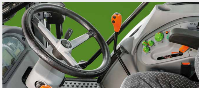
↑ Teleskopowa, wygodnie regulowana kolumna kierownicy dla największego komfortu operatora.
