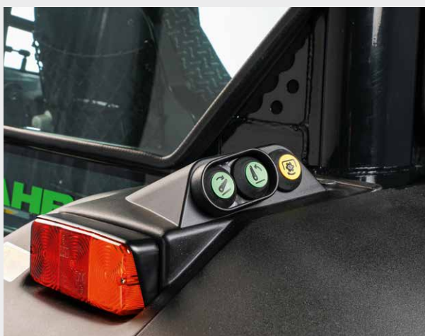
↑ Wygodne sterowanie tylnym podnośnikiem i WOM na błotnikach.
