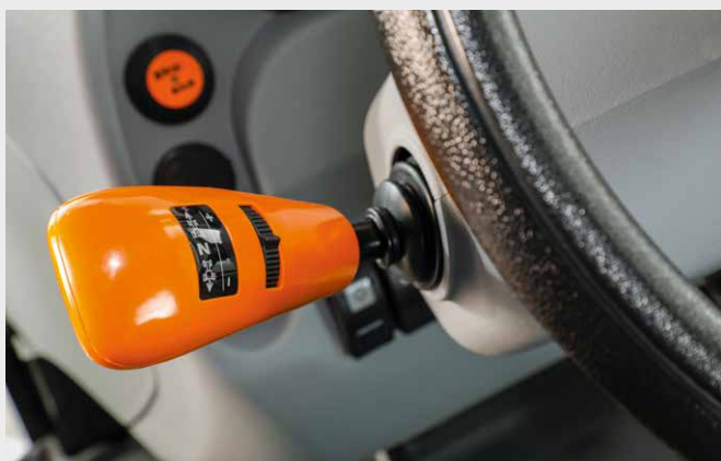
↑ Rewers Powershuttle z pokrętelem regulacji.
