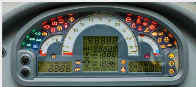
↑ Deska rozdzielcza z zegarami analogowymi i wyświetlaczami cyfrowymi przekazuje wszystkie ważne informacje o parametrach ciągnika.
