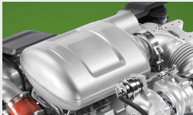
↑ Kompaktowy katalizator DOC (Diesel Oxidation Catalyst).
