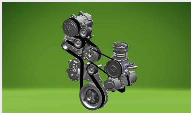
↑ Pasek silnika wzmocniony z układem samoregulacji.
