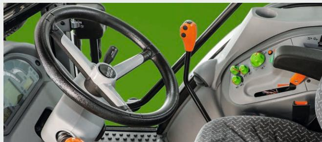
Il volante telescopico, con inclinazione regolabile può essere liberamente adattato al singolo operatore.
