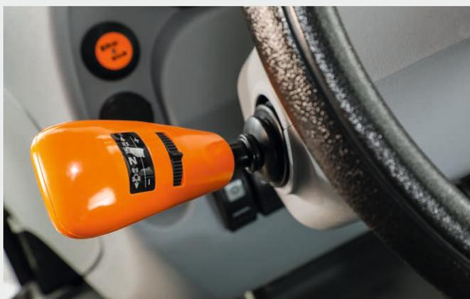
↑ Leva Powershuttle con funzione SenseClutch.
