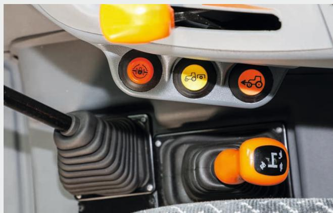
↑ Innesto elettroidraulico della trazione integrale e del bloccaggio del differenziale (LS e GS).
