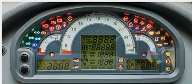
La console con campi di visualizzazione analogici e digitali offre all'operatore una panoramica di tutti i dati del trattore.
