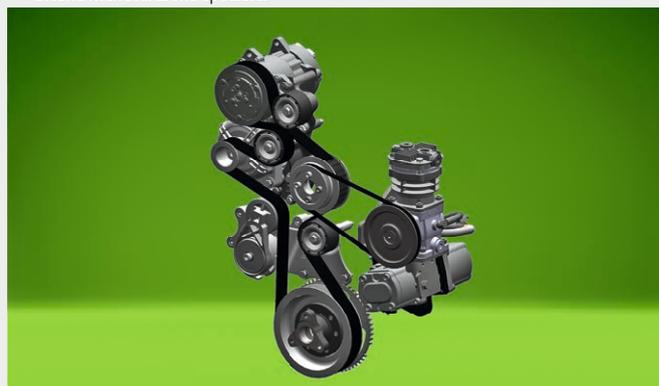
La cinghia di trasmissione a regolazione automatica è una cinghia trapezoidale esente da manutenzione con tendicinghia automatico. Nessun rischio di slittamento della cinghia e quindi di surriscaldamento.
