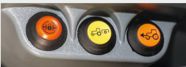
↑ Il funzionamento elettroidraulico della PTO assicura un comodo innesto e un avviamento graduale della PTO.
