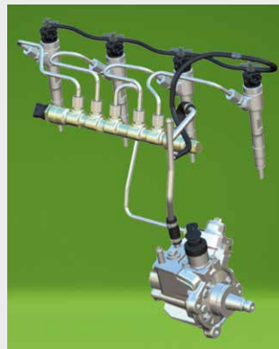
↑ Die innovative Common-Rail-Einspritzanlage sorgt für eine effiziente Kraftstoffverbrennung.
