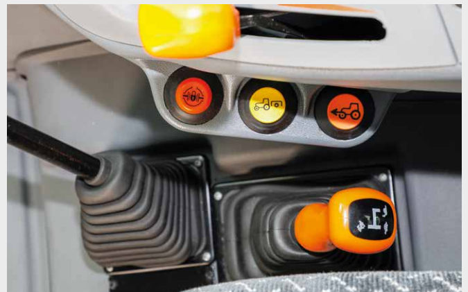
↑ Elektrohydraulische Zuschaltung von Allradantrieb und Differenzialsperre (LS und GS).
