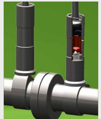
↑ Die automatische Einstellung des Ventilspiels reduziert den Geräuschpegel und ist wartungsfrei.
