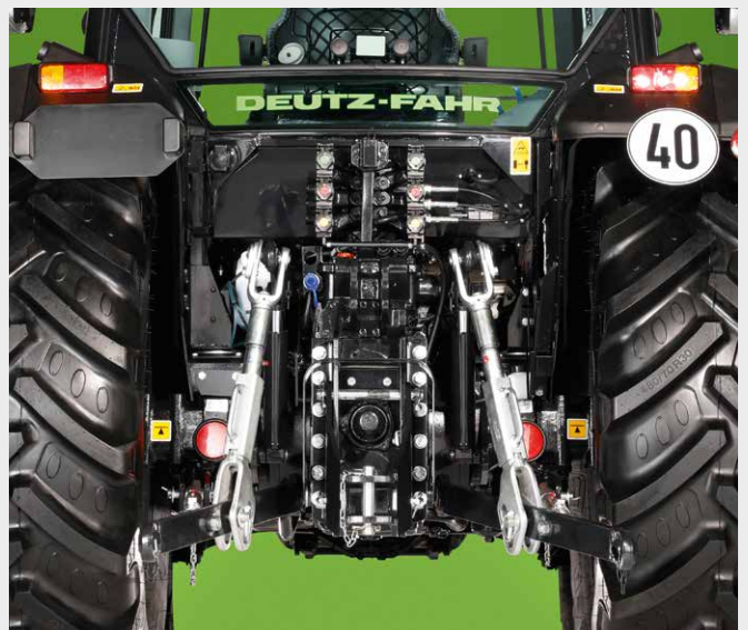
↑ Der heckseitige Kraftheber der Serie 5D ist sowohl mit Schnellkupplern als auch mit Kugelaugen verfügbar.
