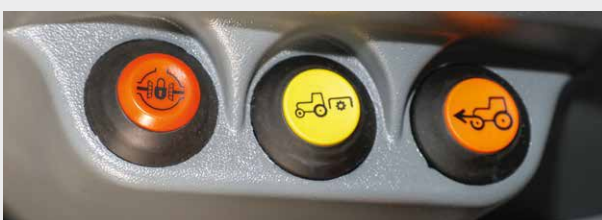
↑ Die elektrohydraulische Zapfwellenbedienung gewährleistet eine komfortable Zuschaltung und sanftes Anlaufen der Zapfwelle.
