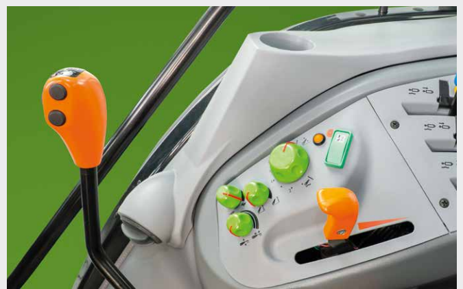
↑ Komfortschalthebel für das 45+45-Gang-Getriebe mit seitlich angebrachten Knöpfen für die Lastschaltung
