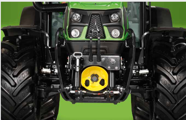
↑ Vorderachse serienmäßig mit zwei integrierten Scheibenbremsen in Ölbad.
