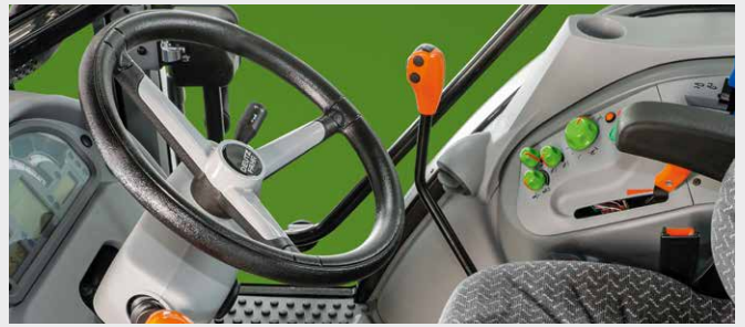
Das im Neigungswinkel verstellbare Teleskopenkrad kann beliebig an die Größe des Fahrers angepasst werden.
