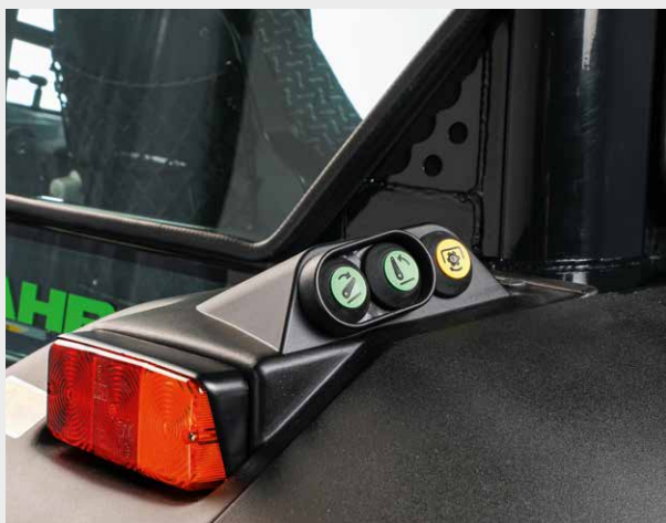
↑ Bequeme Bedienung des Heckkrafthebers und der Zapfwelle vom hinteren Kotflügel aus.
