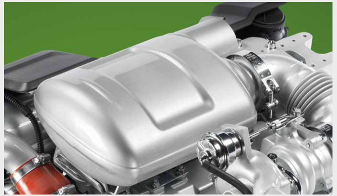
↑ Das kompakte DOC-System (Diesel Oxidation Catalyst) dient der Abgasnachbehandlung und benötigt keine spezielle Wartung.
