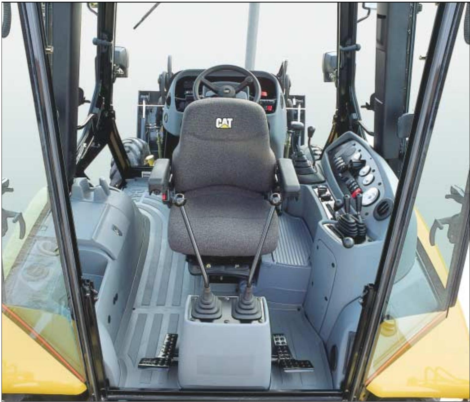
**Кабина экскаватора-погрузчика 438D создана для обеспечения максимально комфортных условий труда и легкости управления**
