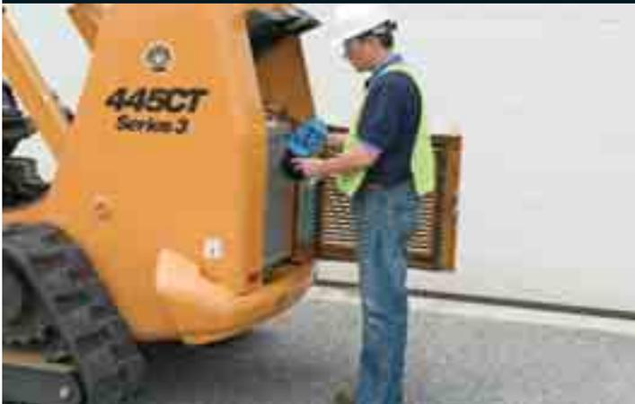
I punti soggetti a manutenzione ordinaria sono facilmente accessibili attraverso il cofano motore ribaltabile e il portellone posteriore completamente apribile. Per una manutenzione più approfondita, l'intera cabina può essere facilmente ribaltata in avanti in modo da offrire un'accessibilità totale al cuore della macchina.
