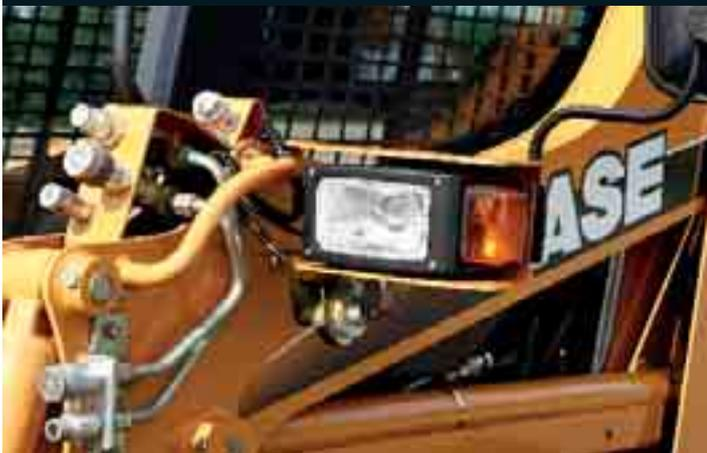
L'impianto idraulico con pompa ad ingranaggi e con distributore a centro aperto a 3 cassette offre una potenza idraulica ottimale. L'impianto idraulico ausiliario di serie (che lavora alla portata e pressione del sistema principale) è in grado di azionare la maggior parte degli accessori. A richiesta è disponibile un circuito idraulico ad alta portata, ideale per l'azionamento di frese, trinciaceppi e altri accessori ad elevato assorbimento di potenza idraulica.
