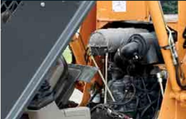
Tutte le minipale compatte cingolate della Serie 3 CT hanno motori diesel turboalimentati, a 4 cilindri, emisionati Tier 3, progettati per Case pensando all'efficienza e al risparmio di carburante. I modelli 420CT (a cinematica radiale) e 445CT (a sollevamento verticale) sono dotati di motori turbo Tier 3 da 3,2 litri che erogano rispettivamente 74 CV e 82 CV. La potente 440CT (a cinematica radiale) monta il motore da 4,5 litri turbo Tier 3 da 90 CV.
