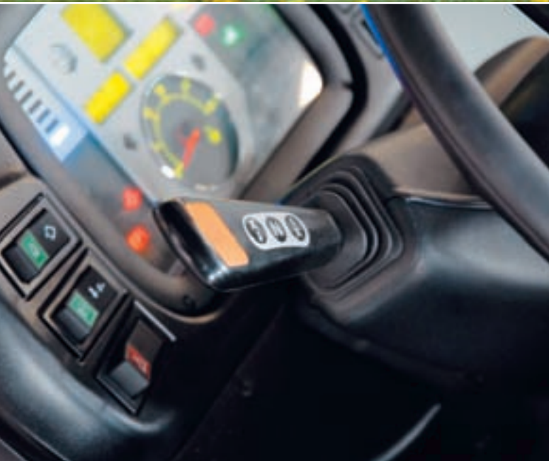
De Powershuttle-hendel bevindt zich handig achter het stuurwiel.
