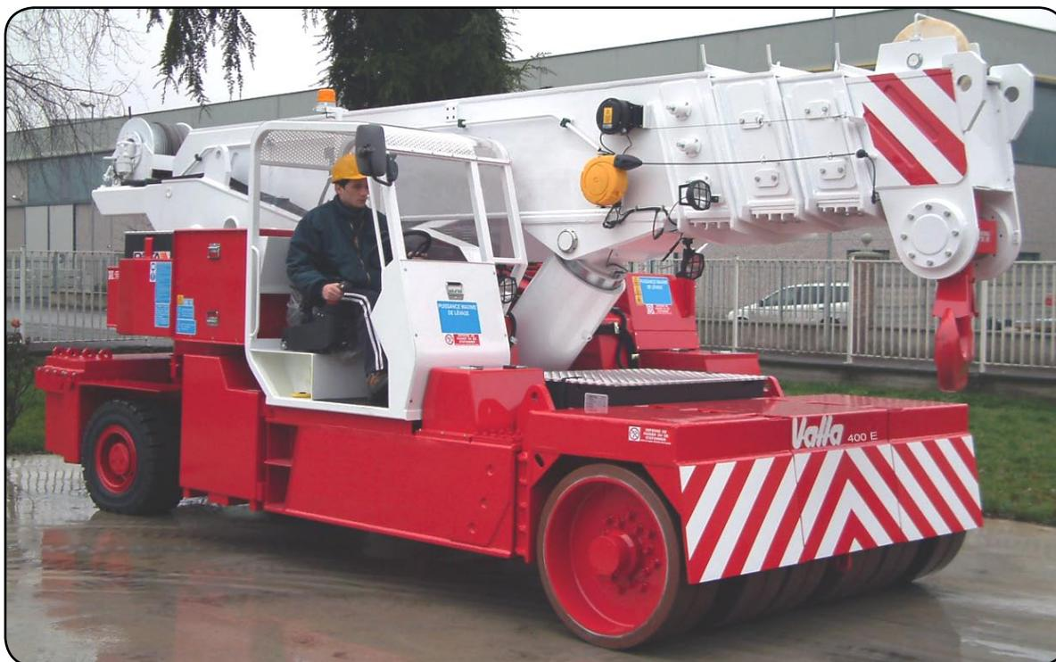
**TRAZIONE:** con motore elettrico DC kW 33 - 96 V, autoventilato, reversibile, comandato da variatore elettronico di velocità a MOSFET con microprocessore.
